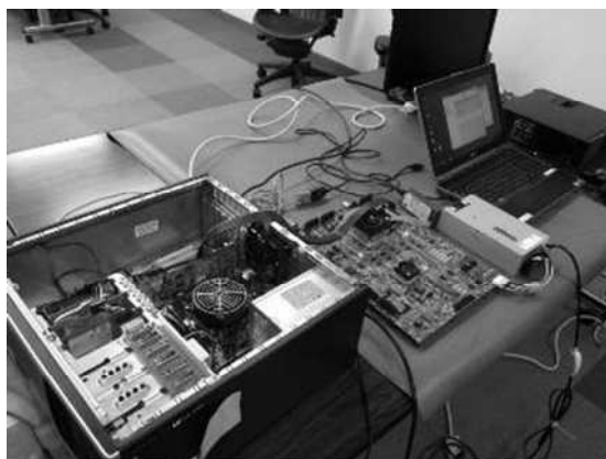
図Ⅲ.2.2.1-5 画像意味理解プロセッサ技術を実装した FPGA 搭載ボードを用いた評価環境
