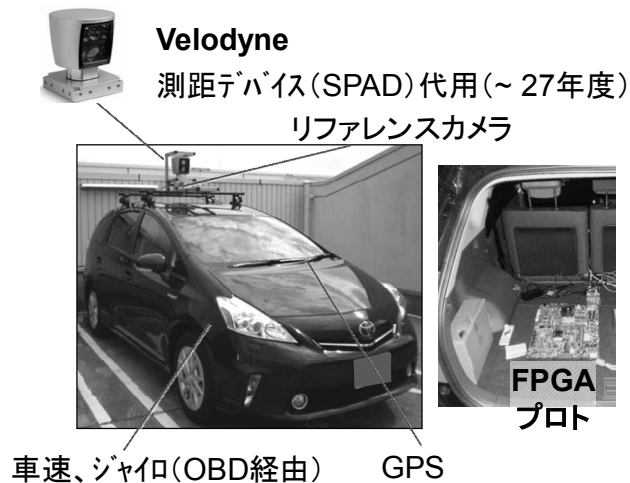
図Ⅲ.2.1.1-9 FPGA プロトと実車評価環境
