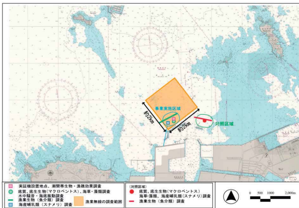
図 3.2.2-15 海草・藻類の調査手法と調査測線
