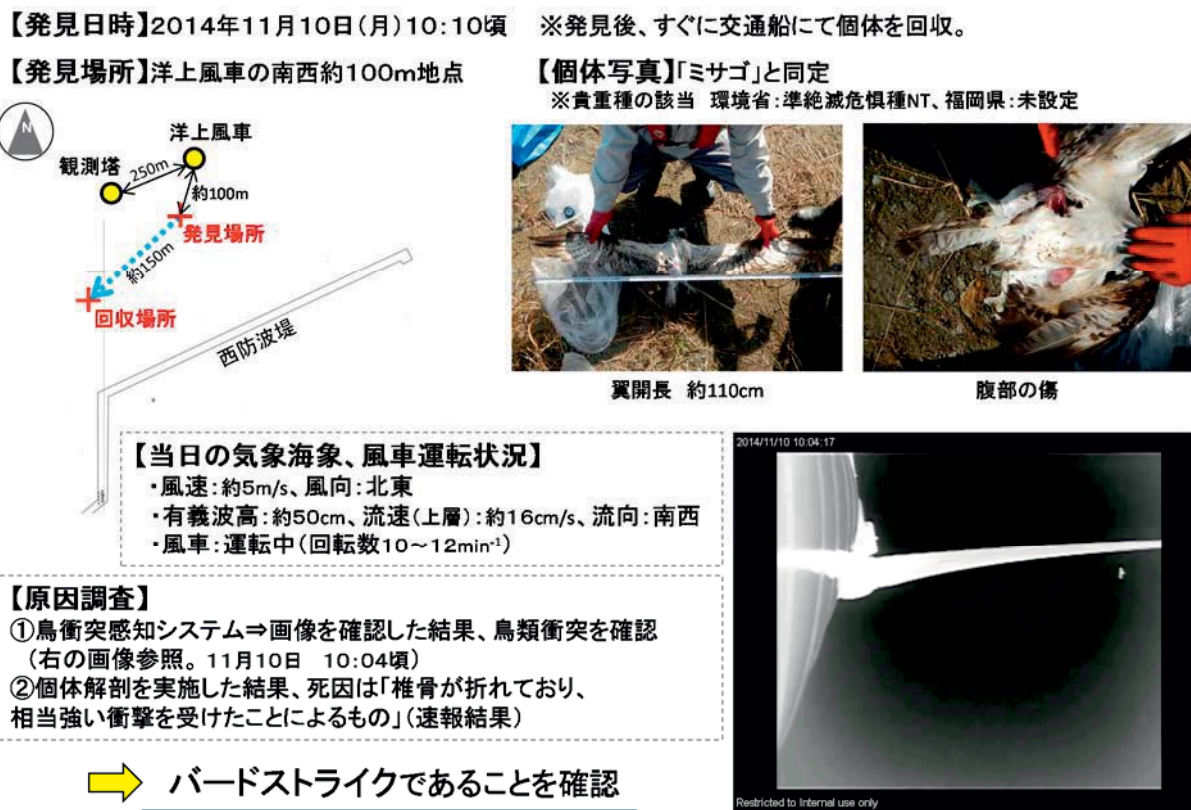
図 3.5.2-20 北九州市沖洋上風力発電施設におけるバードストライク(電源開発資料)
