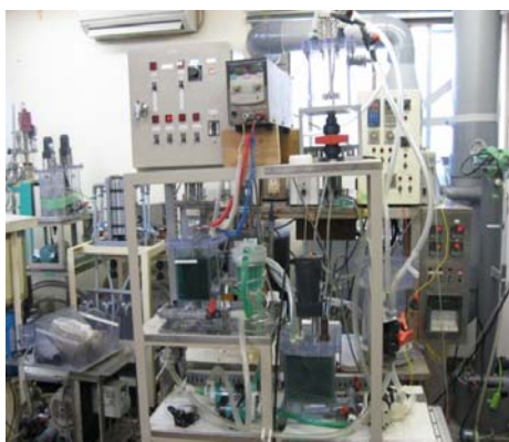
図Ⅲ. 2. 6. 2. 2-11 連続溶出実験装置出実験 図Ⅲ. 2. 6. 2. 2-12 電解析出実験フローシート
