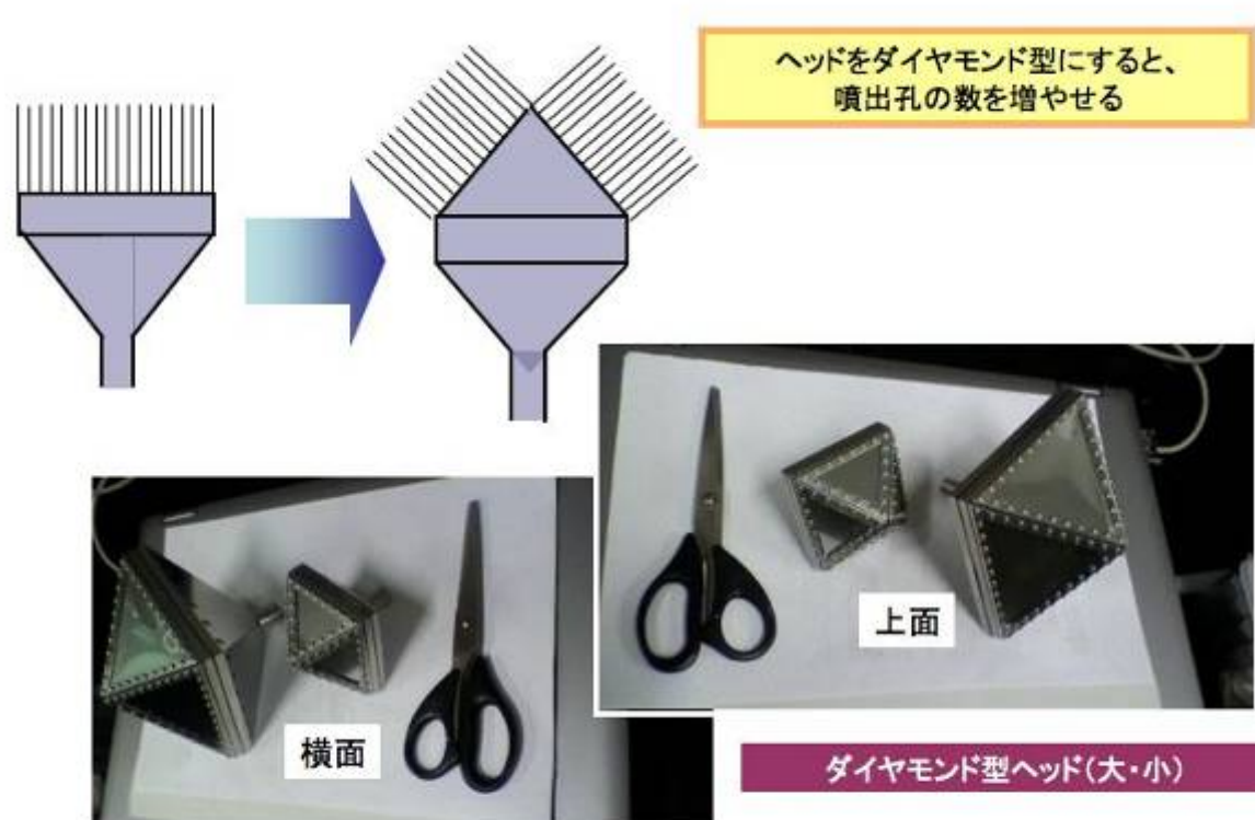
図Ⅲ. 2. 6. 1-24 ダイヤモンド型のヘッド構造とその利点
