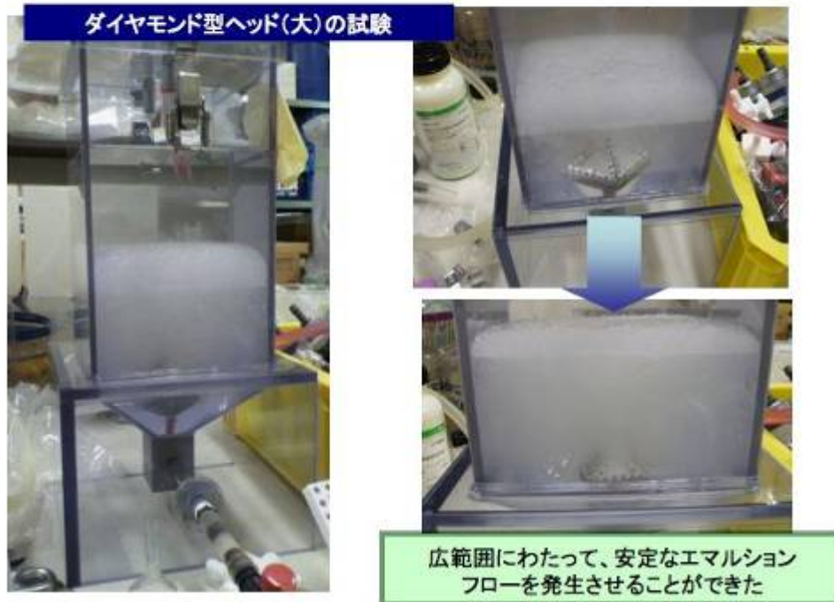
図Ⅲ. 2. 6. 1-26 スケールアップ試験装置を使つての実験の様子
