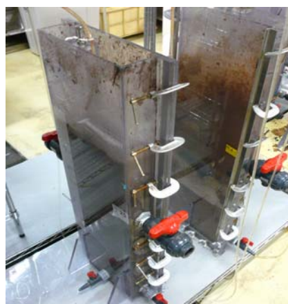
小型試験装置 (水槽容積6L、A4膜エレメント1枚使用)
