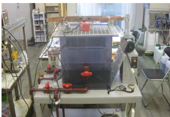
図 II .2.1.6.2-9 電解実験処理装置 (左図：中規模装置 右図：工業規模モジュール)
