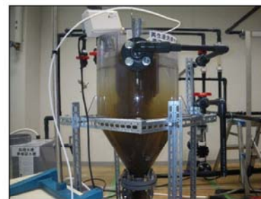
逆洗排水濃縮状況 (フッ素分離、再利用汚泥濃縮)
