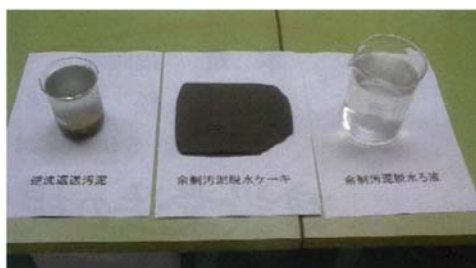
・加圧脱水(脱水ケーキ含水率60%)
