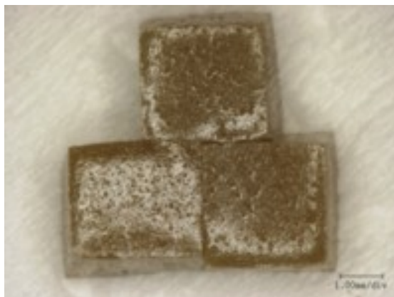
図Ⅲ. 2. 8-18 硝化菌を包括固定化した担体
