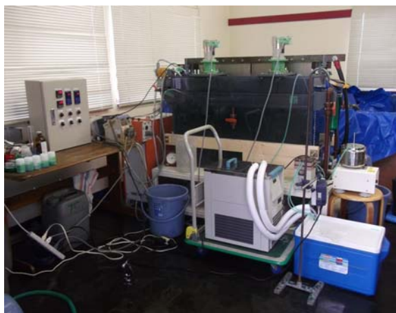
図Ⅱ.2.1.6.2-11 晶析法による電解液中の硫酸ソーダ除去実験（中央下：チラー、右中央：遠心分離器、右：析出槽、中央上：電解槽）
