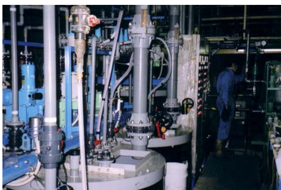
図Ⅱ.2.1.6.2-6 実施現場（左図：反応槽、右図：脱水機・制御盤）
