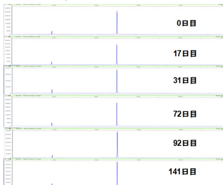
図Ⅲ. 2. 8-40 T-RFLPによるアナモックス細菌叢のモニタリング
