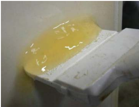
図Ⅲ. 2. 5-24 膜面付着物質写真例と膜面付着物質の成分分析結果
