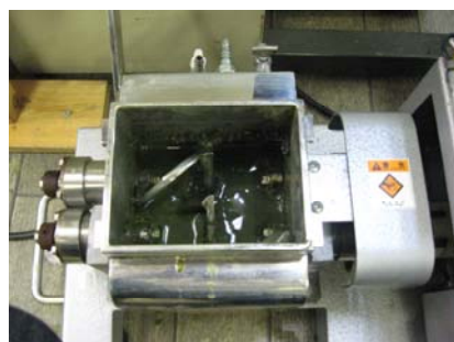
図Ⅱ.2.1.6.2-5 解砕機による金属水酸化物汚泥の解砕実験
