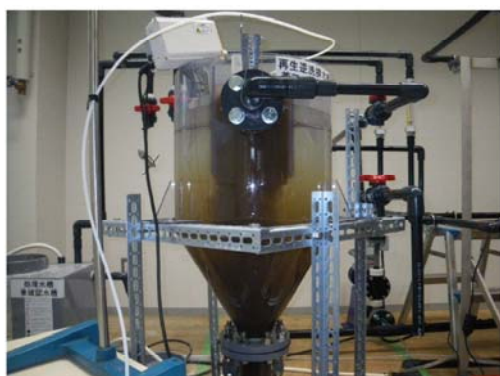
逆洗排水濃縮状況 (フッ素分離、再利用汚泥濃縮) 濃縮汚泥濃度1.5%
