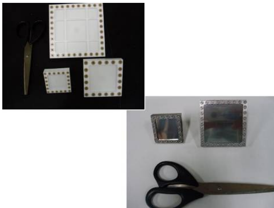
図Ⅲ. 2. 6. 1-21 テフロン製とステンレススチール製の平板状ヘッド
