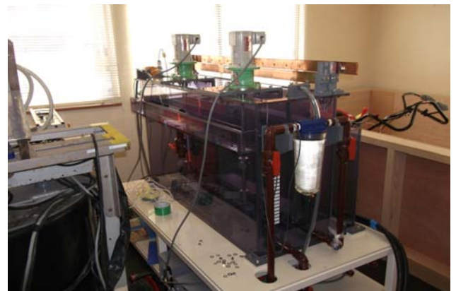
図 II .2.1.6.2-9 電解実験処理装置 (左図：中規模装置 右図：工業規模モジュール)
