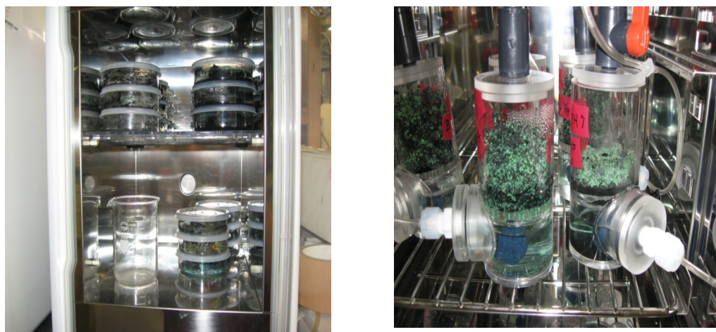
図Ⅱ.2.1.6.2-12 恒温槽内シャーレ（左）、および酸化促進器（右）による硫化ニッケル汚泥の酸化実験
