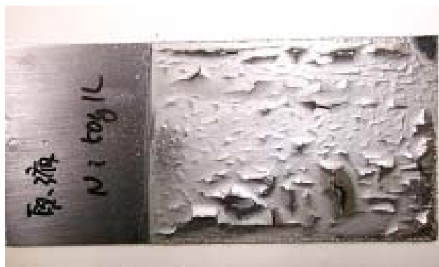
図Ⅲ2. 6. 2. 2-20 未処理電解液の電解析出物
