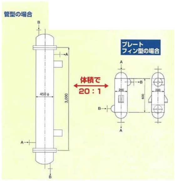
再生熱交換器のコンセプト(メーカーカタログより)
