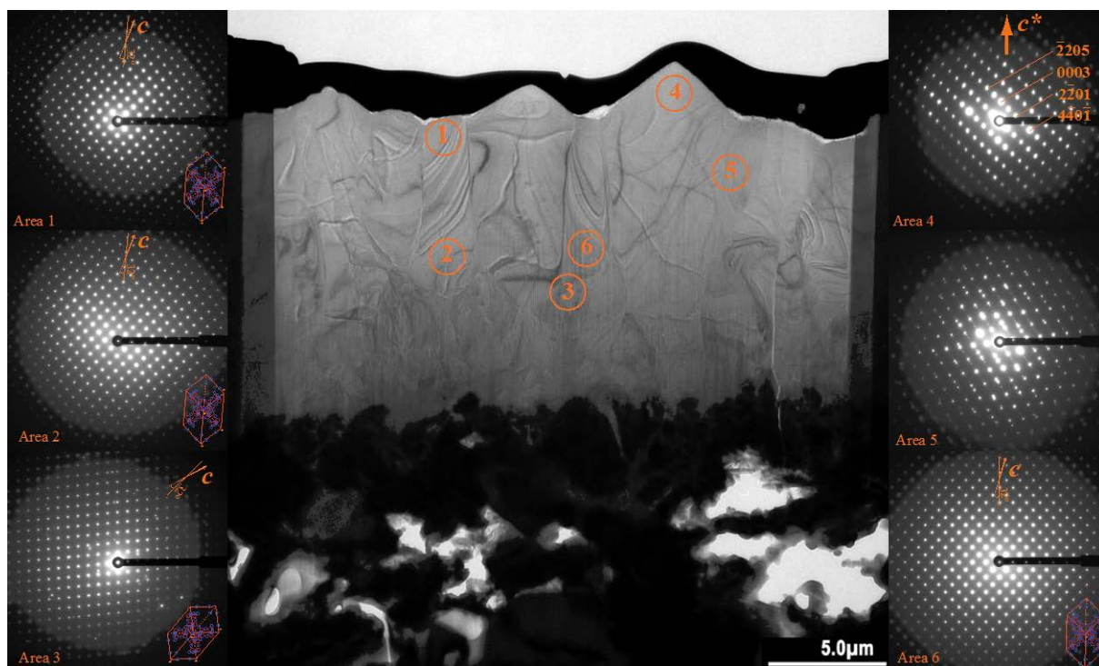
図 2.1.2-29 MSM-1 の断面 TEM 像と対応する電子回折パターン
