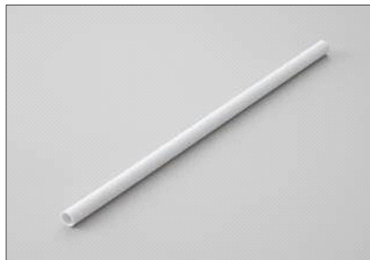
図 2.2.1-2 規則性ナノ多孔膜精密分離膜用多孔質アルミナ基材 (NS-1) の外観 (仕様：外径 10mm 内径 7mm 長さ 400mm)
