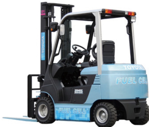
図 6-66 豊田自動織機製燃料電池フォークリフト
