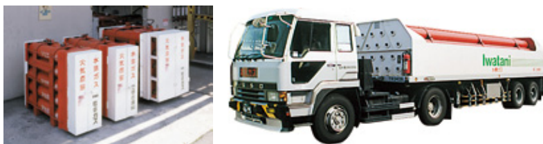
図 6-21 水素カードルと水素トレーラー
