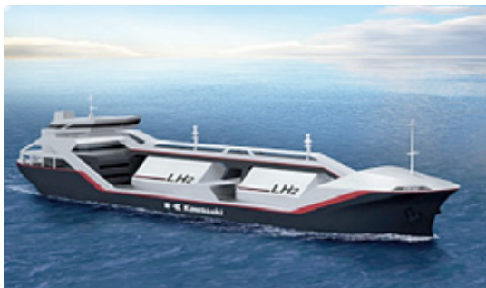
図 6-29 液化水素運搬船のイメージ
