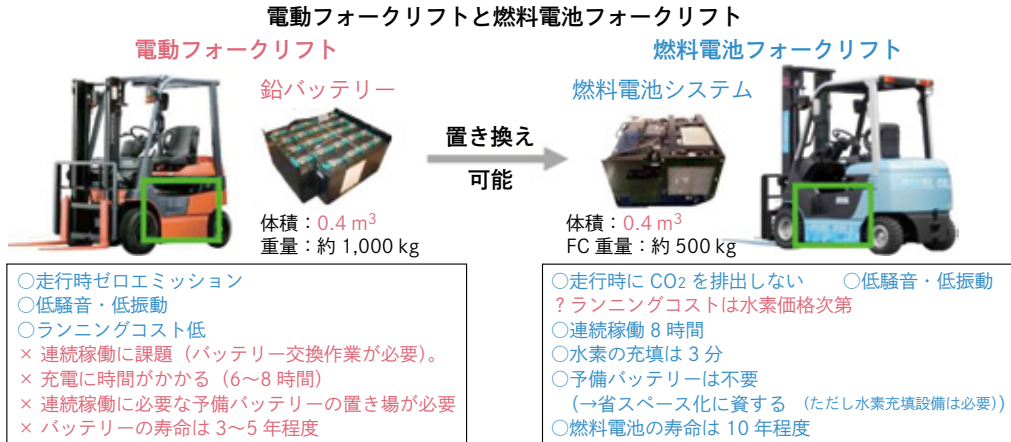
図 6-63 電動フォークリフトから燃料電池フォークリフトへの置き換えのメリット
