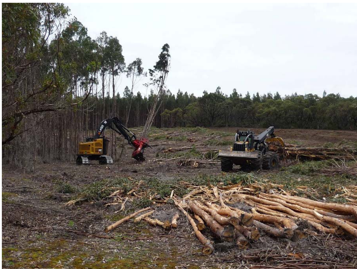
写真 III-2-2-4 フェラーバンチャー（左）による伐採
