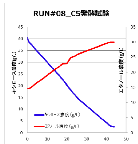
図Ⅲ-2-1-3-(7)-3 ベンチスケールでのキシロース発酵酵母の性能評価
