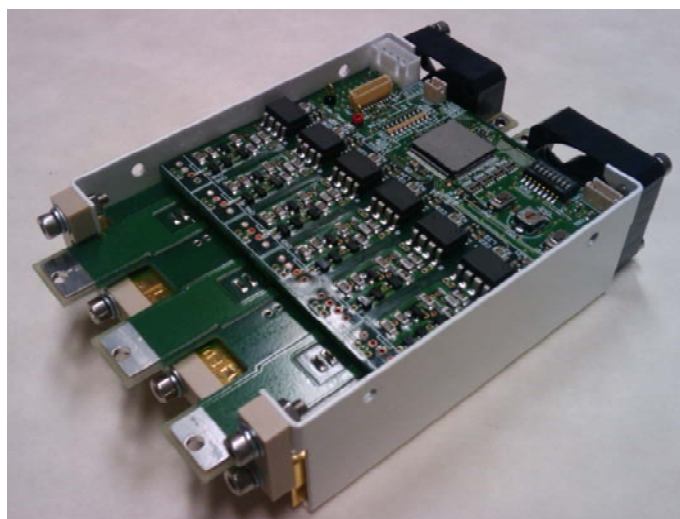
図Ⅲ.2.3.2.2-17 高速動作ゲート駆動回路を組み込んだ3相インバータ
