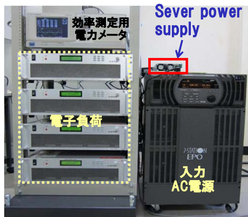
図Ⅲ.2.1.2.2-7 サーバ電源の電源効率評価系
