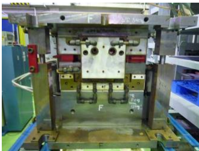
図②-1-7 単純形状成形用金型
