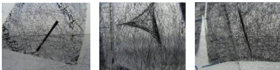
図①-1-17 開織不良のパターン
