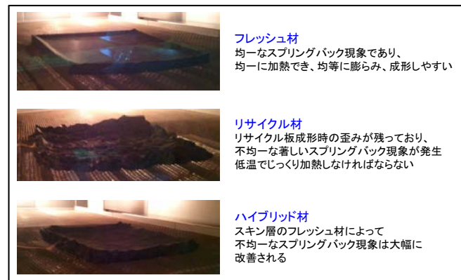
図④-1-27 ハイブリッドリサイクル材のスプリングバック現象
