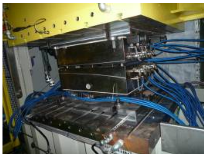
図②-1-18 ヒート&クール金型
