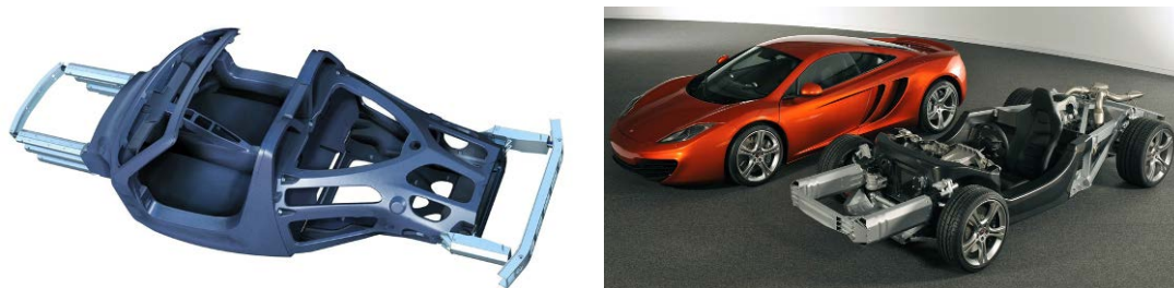
図③-2-2 Porsche Carrera GT (2004) [ http://press.porsche.com/ ]と McLaren MP4-12C (2011) の CFRP ボディ [ http://media.mclarenautomotive.com/ ]
