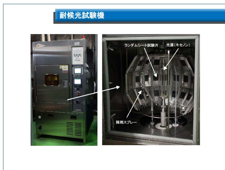
図①-2-22 耐候光試験機
