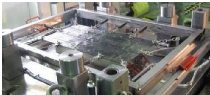
図②-1-122 連続繊維材の成形システム
