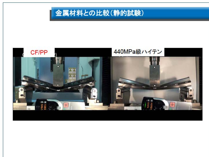
図②-3-10 CF/PP系とハイテンの変形挙動
