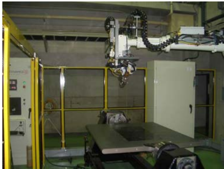
図②-1-74 立体積層用テーププレースメント装置
