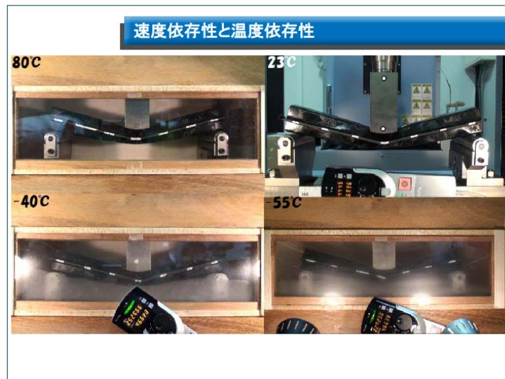
図②-3-34 モデル部材の変形挙動
