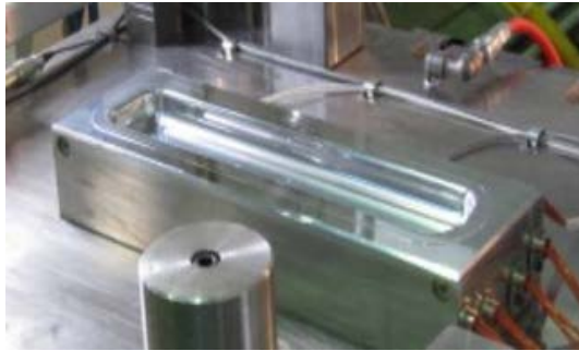
図②-1-123 連続繊維材用の金型外観図
