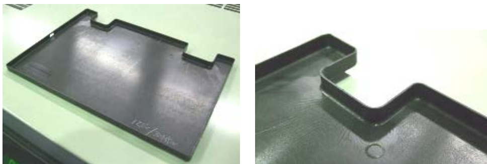
図②-1-37 プレス／トリム同時成形品
