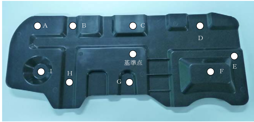
図②-1-45 複雑要素形状品の変位量測定箇所
