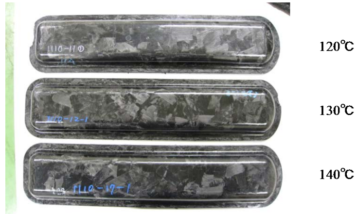
図②-1-121 成形品の外観（図中の温度は金型温度）
