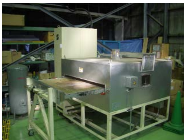
図②-1-100 IR ヒータ外観図
