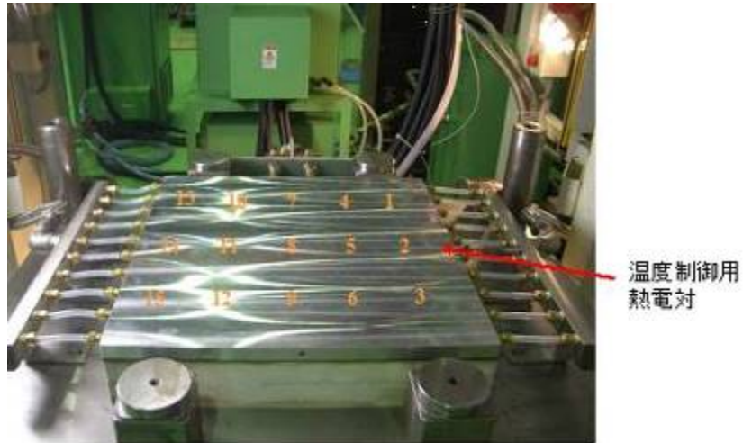
図②-1-136 急速加熱冷却設備用金型外観図
