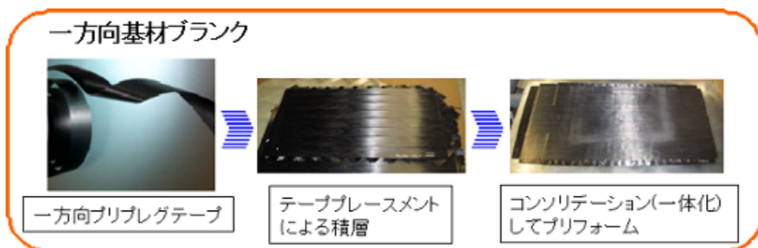
図②-1-69 プリプレグテープの積層、コンソリデーションによるシート化
