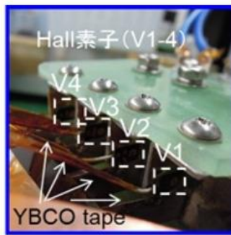
図 2.1.5-4-4 ホール素子の(a) 全体写真(b) 端末の写真(c) 模式図
