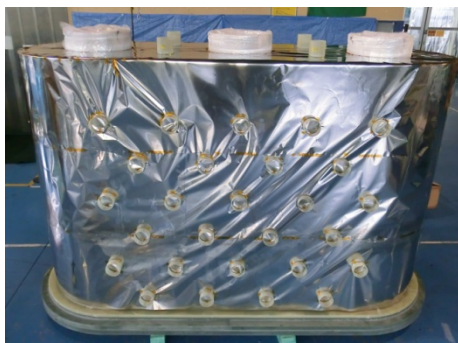
図 2.3.5-15 保冷容器（シールド施工時） 図 2.3.5-16 保冷容器（完成時）
