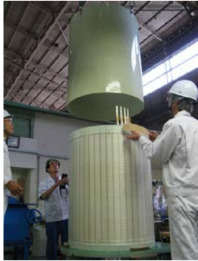
巻線組立作業
