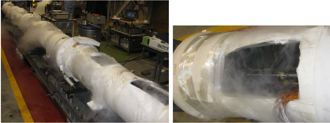
図 2.2.1-81 三心コアサンプルの LN 2 中での引張試験状況
