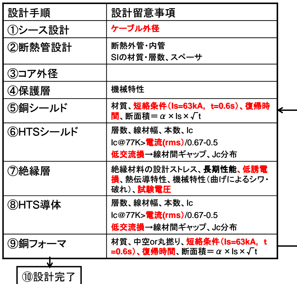
図 2.2.3-16 275 kV 超電導ケーブルの設計フロー
