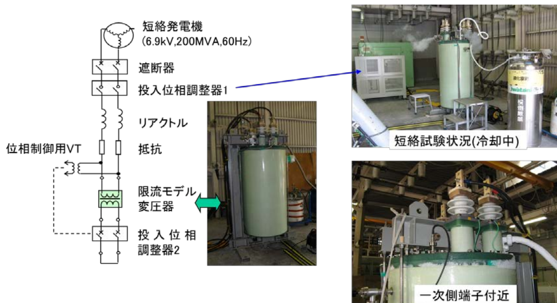
図 2.3.3-46 限流特性試験回路とその写真
