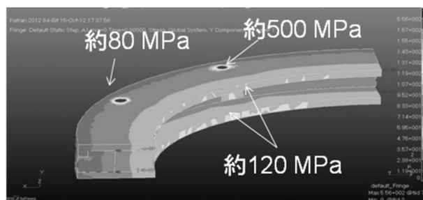
図 2.1.5-2-14 周方向応力分布の解析結果
