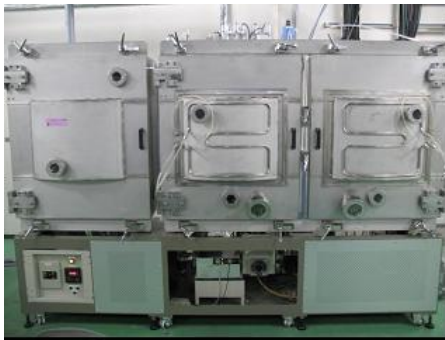
図 2.3.4-15 Reel-to-Reel 式連続高周波スパッタリング装置
