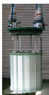
① 巻線技術 短絡、低損失、大電流等の検証 (短絡400kVA)
