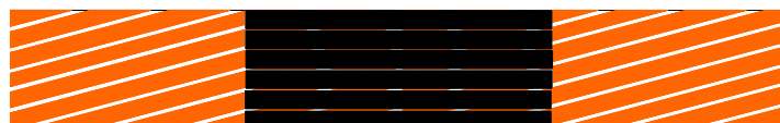
図2.2.3-76 スパイラルに巻き付けられた場合の超電導線材の接続
