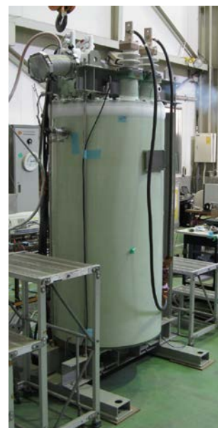
図 2.3.1-15 鉄心付大電流巻線モデルの諸元と外観
