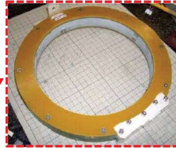
コイル通電 1,500A(電源の最大出力) @ 8 T.
