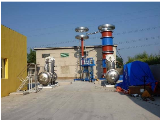
図 2.2.4-9 終端容器の設置（左）、ケーブルと終端容器の接続（右）
