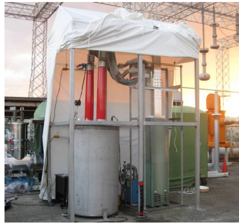
図 2.2.1-84 3500 mm 2 電流リードと熱損失測定試験
