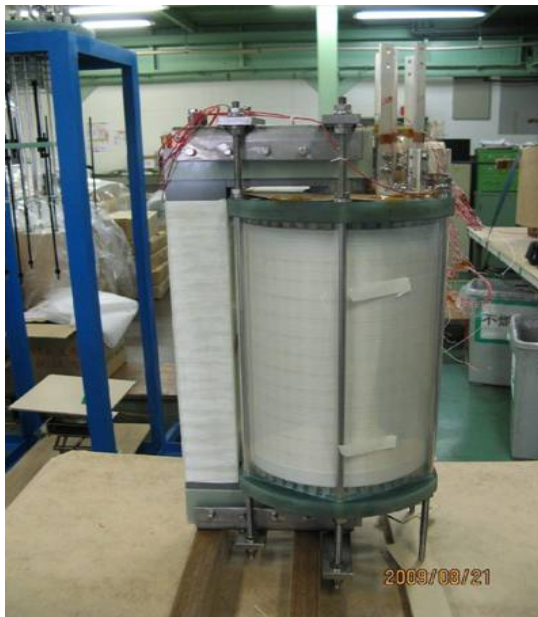
図 2.3.3-4 4巻線構造変圧器 (巻線、鉄心) の外観
