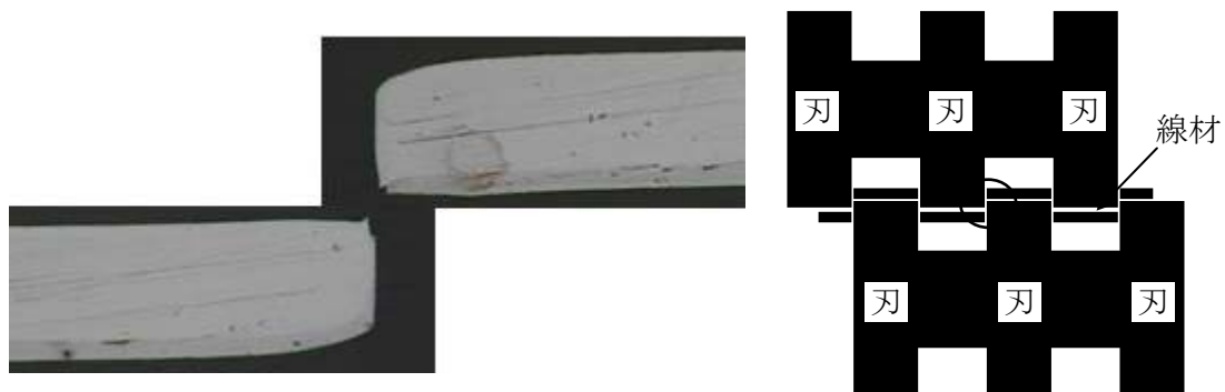
図 2.4.3-106 適正化後の切断エッジ形状と機械スリット模式図
