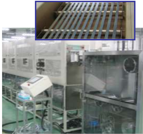
図 2.2.5-18 Reel-to-Reel 式連続塗布塗布仮焼炉の全景
