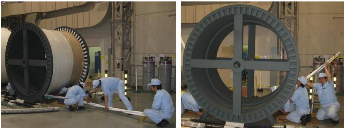
図 2.2.1-78 三心ケーブルコアの曲げ試験
