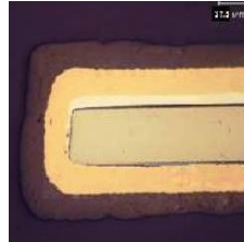
図 2.1.5-2-3 液状樹脂で被覆した超電導線材の断面
