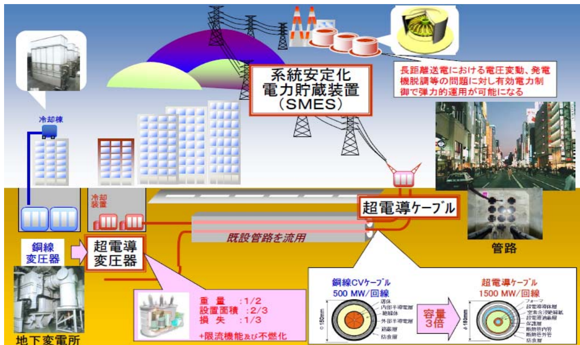
図1-1 超電導電力機器による都市部への大容量安定供給の概念図
