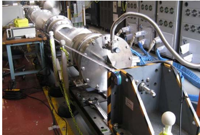
図 2.2.1-94 中間接続部の冷却機械試験風景
