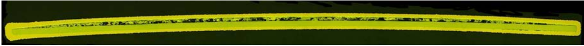
(a) 改善前の Cu めっきによる Cu 安定化線材 (1cm 幅)
