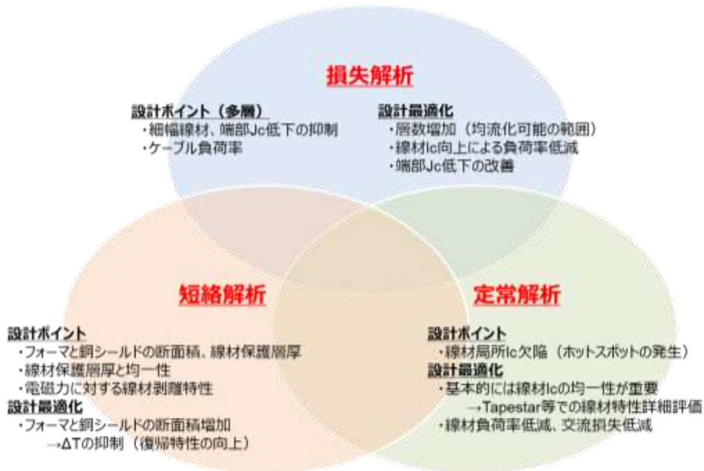
図 2.2.2-17 三心一括型超電導ケーブルの設計ポイント
