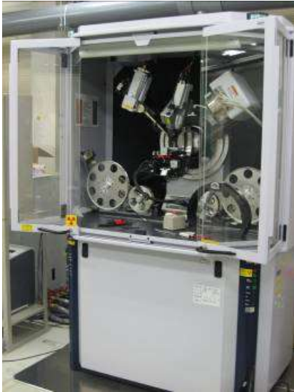
図 2.2.5-47 Reel to Reel-X 線回折装置 図 2.2.5-48 200 m 長の中間層 (CeO 2 ) の面内結晶粒配向評価結果 (5 m 間隔)
