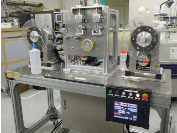
図 2.4.3-76 Reel to Reel マスクテープ 貼り合わせ機の外観 図 2.4.3-77 Reel to Reel エッチング 貼り合わせ機の外観
