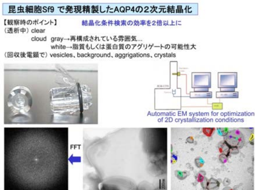
図11 2次元結晶化条件を探索するために、画像を自動で撮影し蓄積する自動電子顕微鏡を開発した。
