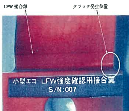
図III 2. 1. 1. 1(2)-6 疲労試験後の翼形状試験片外観
