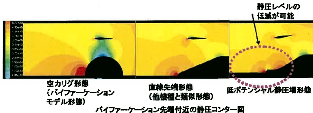
図III.2.2.1.1-1) (4)e-2 先端形状の比較計算結果
