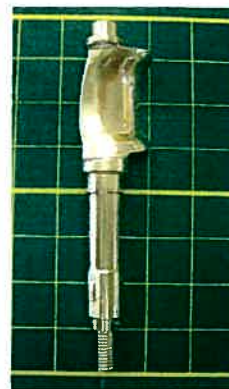
圧縮機可変静翼 (単翼) の試作例
