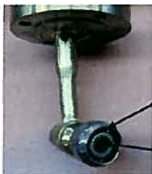
燃料ノズル単体試験噴霧状況可視化写真
