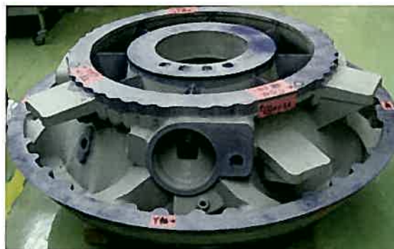
試鋳造したアルミ製フロントフレーム
