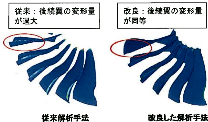
図Ⅲ2.2.1.3-4 鳥衝突解析結果
