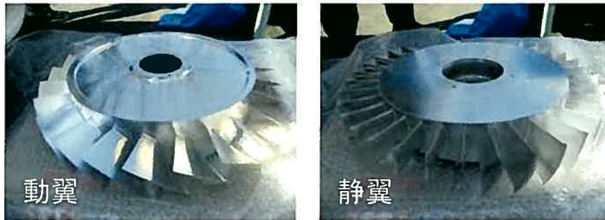
図Ⅲ-2.2.1.1-2）(2)-20 遷音速段を模擬した試作動・静翼列
