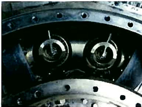
(a) 燃料噴射弁2個のセクタ試験
