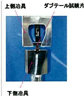
翼結合部の疲労試験(寿命予測)
