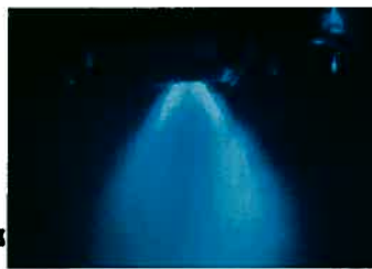
燃料ノズル単体試験噴霧状況可視化写真
