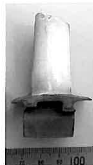
図III 2.1.1.1(3)-13 レーザーCVDで翼面にYSZコー ティングを形成したタービン動翼
