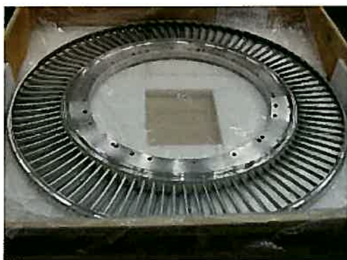
図III 2.1.1.1(3)-15 低圧タービン初段静翼
