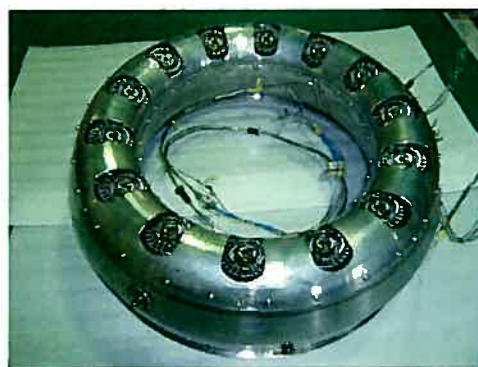
図Ⅲ2.2.1.1-2）(3)c-5 部分希薄燃焼器アニュラ試験用供試体
