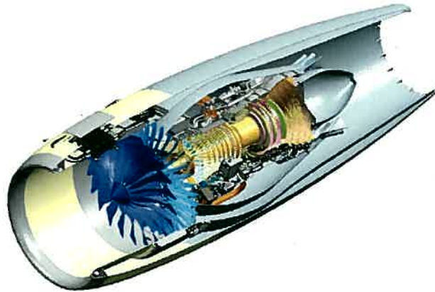
図Ⅲ1.1(2)-1 燃費重視仕様エンジンの3次元モックアップ図
