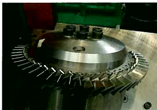
図III 2. 1. 1. 1(2)-6 疲労試験後の翼形状試験片外観
