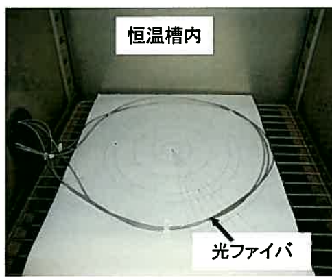
図Ⅲ2.1.1.2-4 モニタリングセンサ光ファイバ単体試験風景
