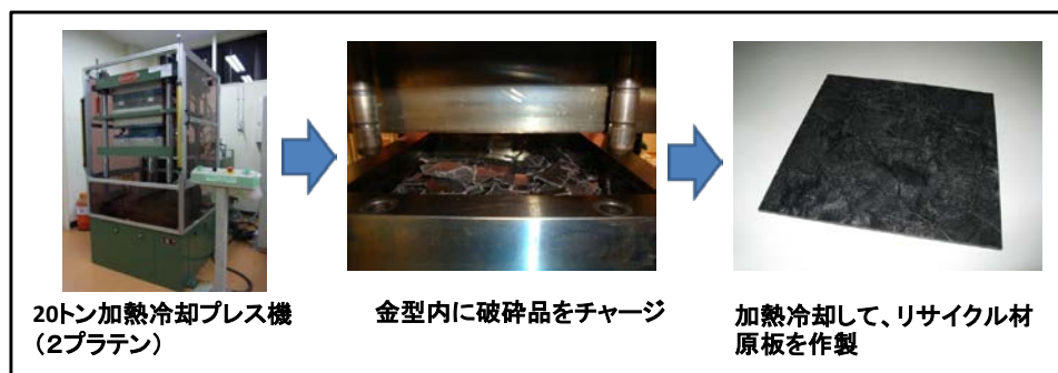
図④-1-20 破砕品からのリサイクル材原板の成形
