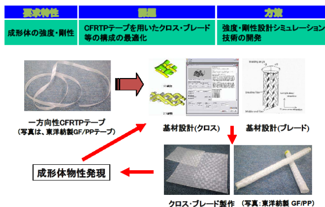
図①-2-27 研究開発項目①-2-4「一方向性 CFRTP 中間基材の設計・開発」 アウトライン
