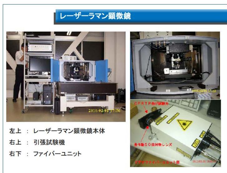
図①-2-53 レーザーラマン顕微鏡、卓上引張試験機、並びにファイバーユニット
