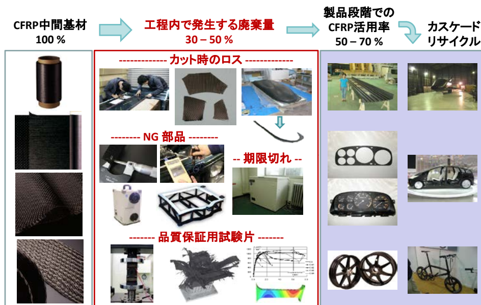
図④-1-1 熱硬化性 CFRP の場合の廃棄 CFRP 量
