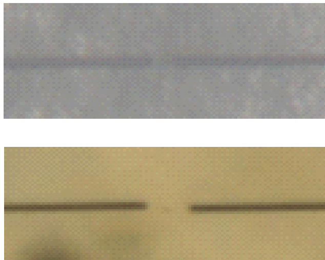
図①-1-12 ポリプロピレン樹脂中の繊維の破断部分 (上： 固体状態 下：溶融状態)
