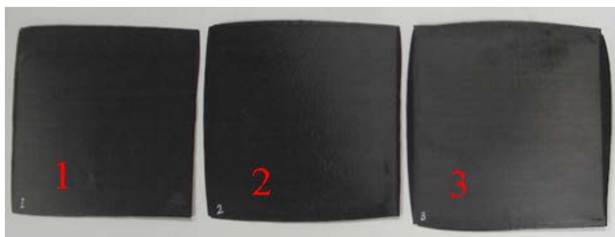
図②-1-138 CF/PP 系 直交積層品のコンソリデーションサンプル
