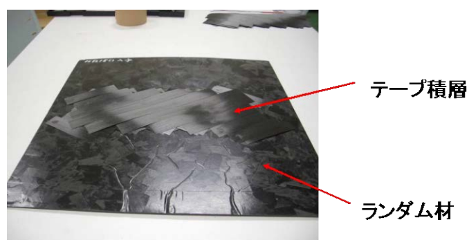
図②-1-73 テーププレースメント装置で作成した CFRTP ハイブリッド材
