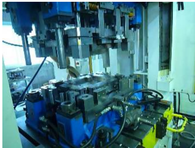
図②-1-36 複雑形状成形用金型（プレス-トリミング一体型）
