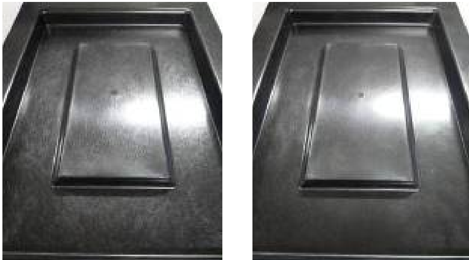
図②-1-20 ヒート&クール成形の外観への影響 (左：通常の成形品 右：ヒート&クール成形品)
