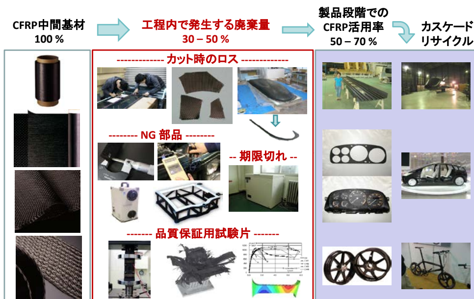
図 II.2-9 CFRP の場合の廃棄 CFRP 量
