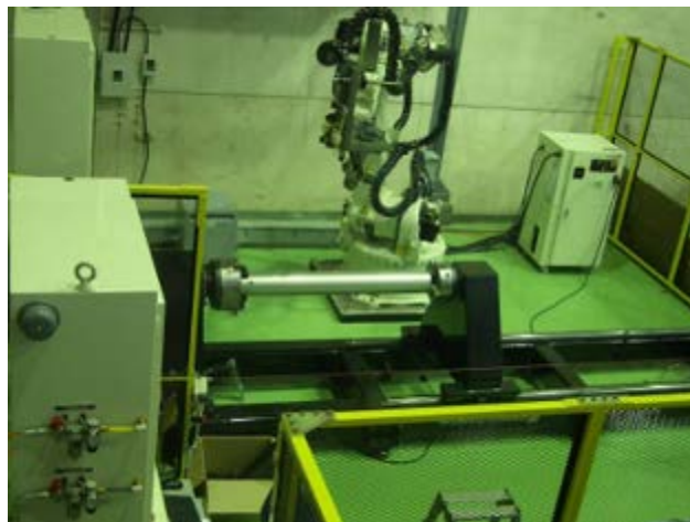
図②-1-76 円柱状治具の設置状況
