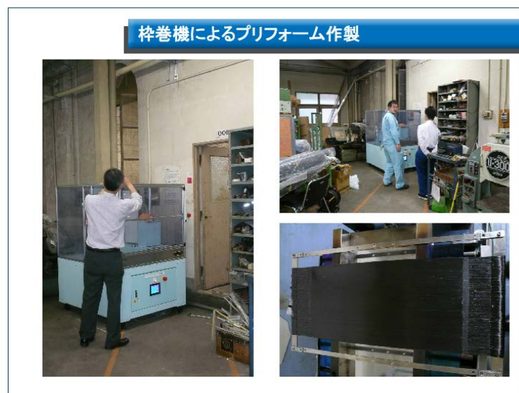
図①-2-14 枠巻機によるプリフォーム作製
