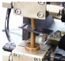
図③-1-12 初期検討に使用したラボレベルの融着装置
