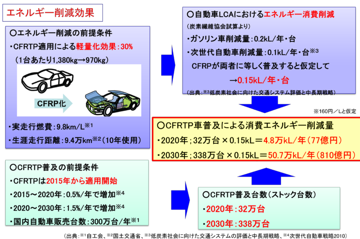
図 I.1-3 CFRTP 適用車普及によるエネルギー削減効果
