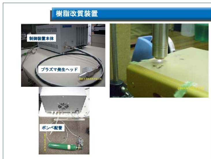
図①-2-17 樹脂改質装置
