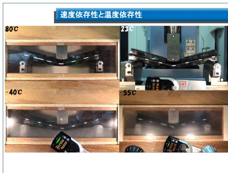
図②-3-34 モデル部材の変形挙動
