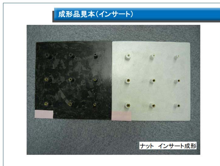
図②-1-142 流動性評価結果を致した成形実証例（ナット・インサート）
