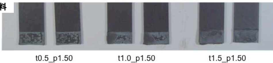
図③-1-20 一方向性材料と等方性材料の超音波融着時間に対する破断面の比較
