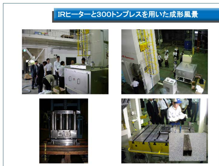
図②-1-66 高速スタンピング成形の例
