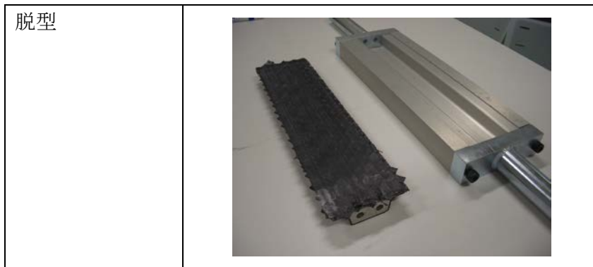
図②-1-82 ハットチャンネルのテープによる補強
