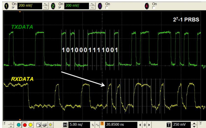
図Ⅲ. 2. 6. 2-32 クロック再生回路込みの送受信機システム対向通信実験の結果
