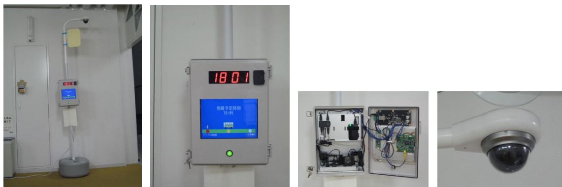
図 2.2-13 知的バス停システムの外観(左から全景、表示部、制御部、天頂カメラ)
