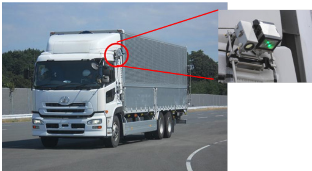
図Ⅲ.2.2.(4)-13 高速ビジョンカメラの搭載状態
