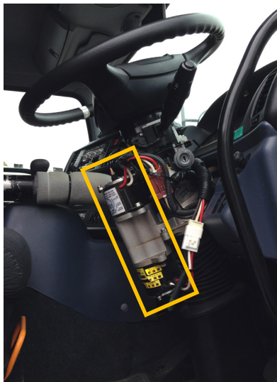
図Ⅲ.2.2.(1)-7 操舵モータ搭載状態
