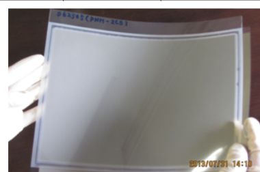
試作した全印刷TFT駆動電子ペーパー
