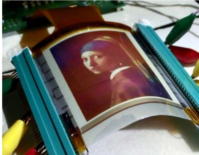
図Ⅲ-2.3.2-10 3.5 インチフレキシブル mECD パネル (113ppi) の表示画像
