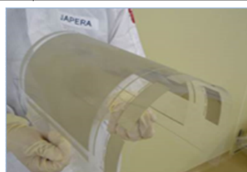
試作した全印刷製造TFTシート
