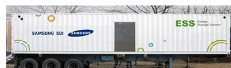
2MW/500kWhシステム (サムスンSDI社 リチウムイオン電池)
