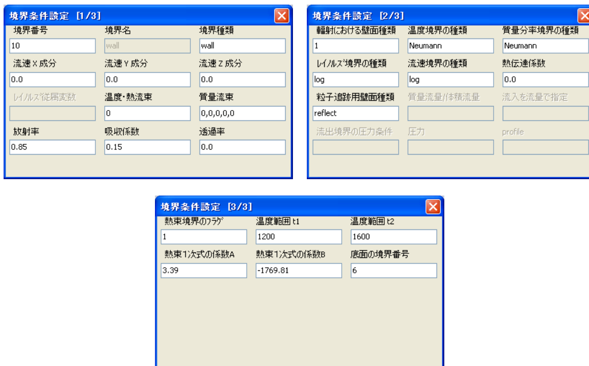
図III-2-①-3-92 燃焼解析の境界条件設定パネル
