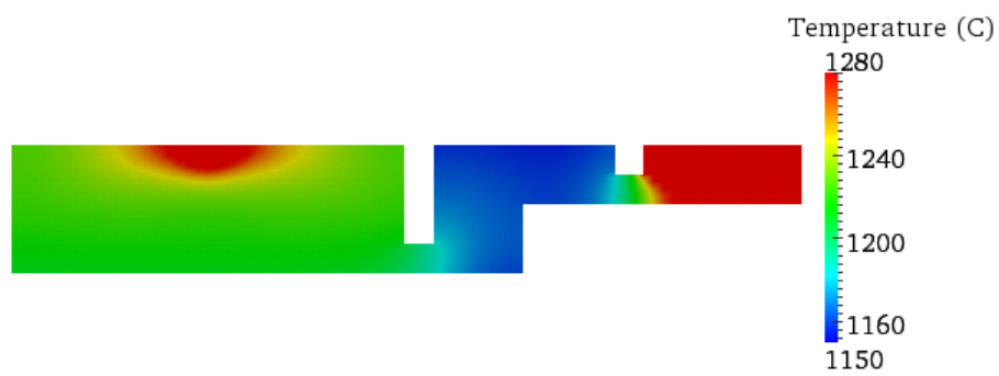
図Ⅲ-2-①-1-40 溶融槽温度分布 (Y断面)
