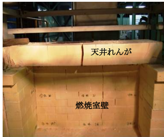
図Ⅲ-2-①-1-52 使用後の試験炉燃焼室内部
