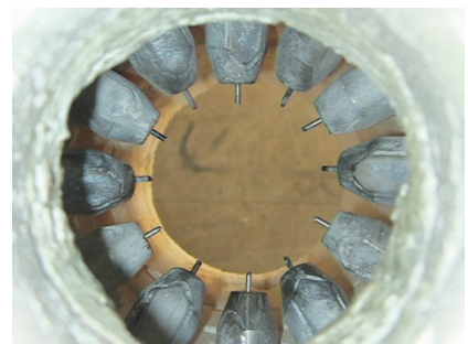
図 III-2-①-2-51 放電電極部の点火前写真
