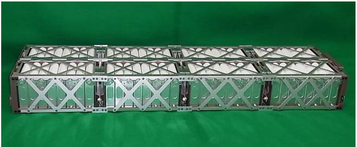
図 .2.1.2-3 3kWh組電池のモックアップ
