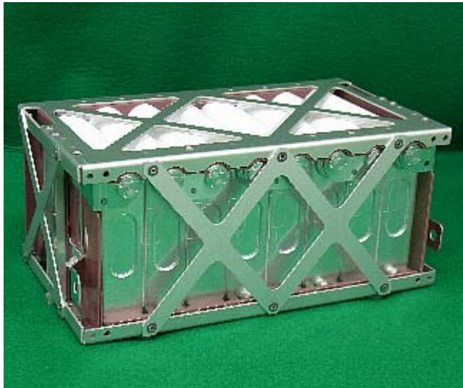
図 .2.1.2-2 開発単電池及び8セルモジュール
