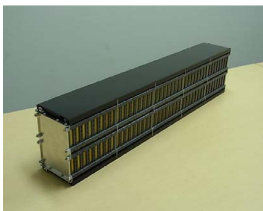
図 .2.1.1-23 電池パックの外観写真
