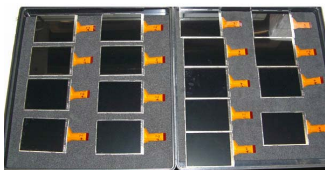
図3. 74 試作した3インチ液晶パネル群の一部
