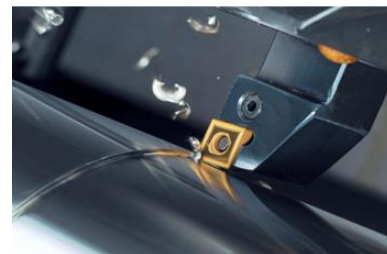
図Ⅱ-1-13 超硬工具使用事例
