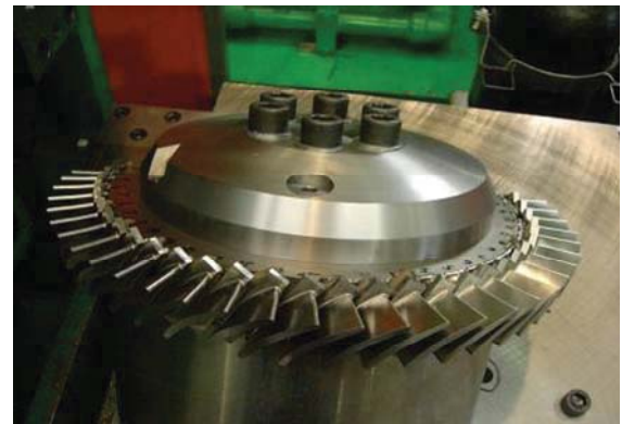
図III2.1.1.1(2)-6 疲労試験後の翼形状試験片外観
