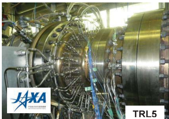
JAXA 環状燃焼試験設備に搭載されたフルアニューラ供試体
