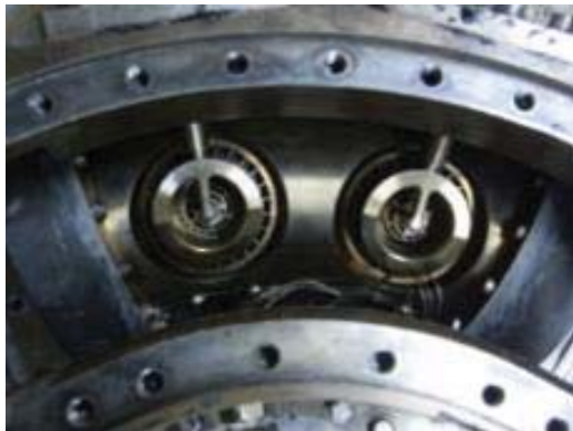
(a) 燃料噴射弁2個のセクタ試験
