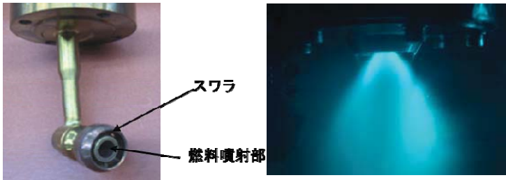
燃料ノズル単体試験噴霧状況可視化写真
