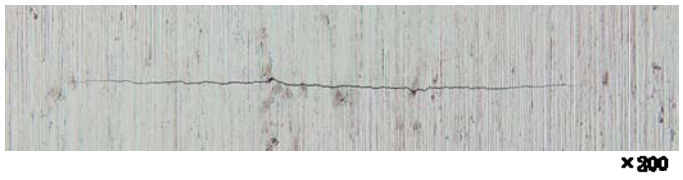
疲労クラック作成手順と得られたクラックの拡大画像 図Ⅲ2.2.1.1-1) (4)d-2
