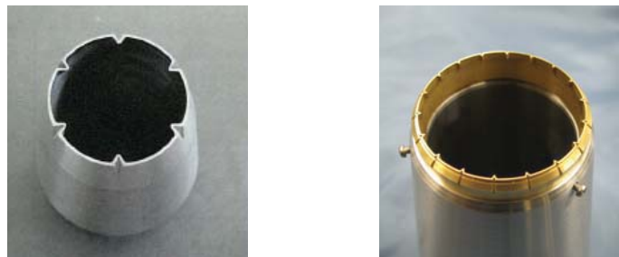
第 2 期のオリジナルノッチノズル 第 3 期の改良ノッチノズル 図Ⅲ2.2.1.1-1）(4)f-1 考案したノッチノズル
