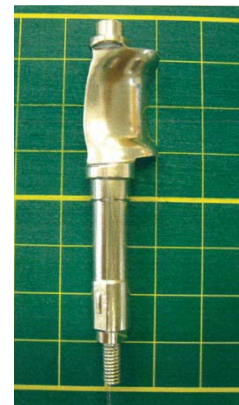
圧縮機可変静翼（単翼）の試作例 図 III 2.2.1.1-1) (5)c-3
