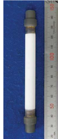
コーティングを施工した 単結晶合金試験片
