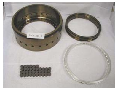
設計確認試験（VSV 機構耐久、作動反転ベアリング耐久）
