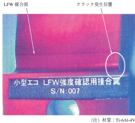
図III2.1.1.1(2)-6 疲労試験後の翼形状試験片外観
