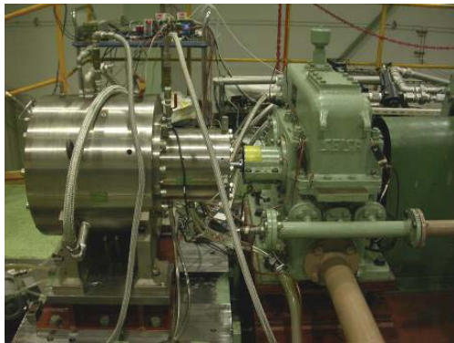
非接触シール特性データベースの取得 図Ⅲ2.2.1.3-17 耐空性適合化技術各種試験の例
