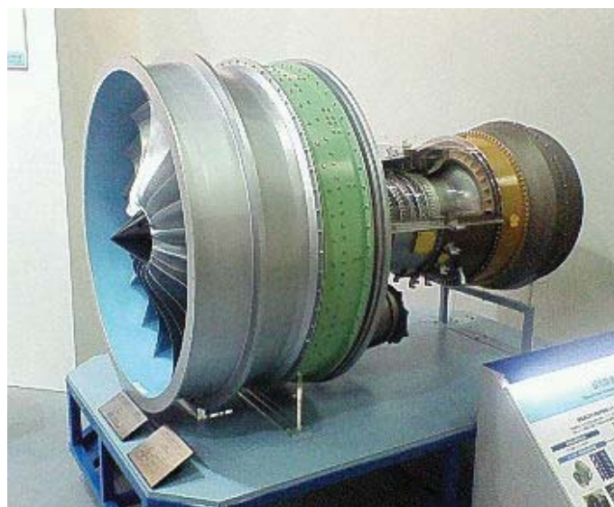
図III.4(2)-2 エコエンジンモックアップ模型
