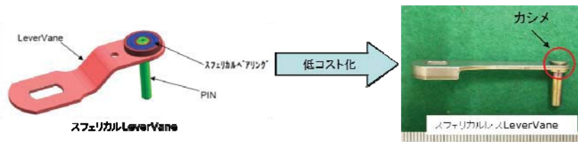
図Ⅲ2.2.1.1-1) (4)b-3 スフェリカルレス Lever Vane
