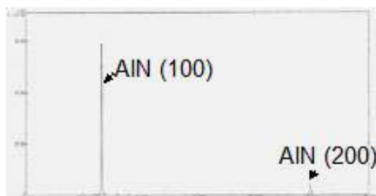
図 2-42 X 線回折 ( \theta - 2\theta ) による評価結果
