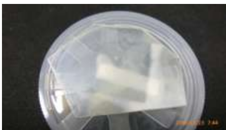
図 2-1 Na フラックス GaN 基板 (MJ0158) 上のアンドープ GaN/AlGaN
