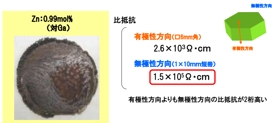
図 1-49 Zn 添加 GaN 基板から切り出したサンプルの比抵抗測定結果
