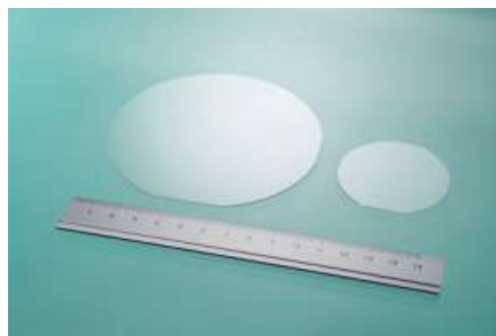
図 1-35 有極性 2inchφ GaN 結と有極性 4inchφ GaN 結晶
