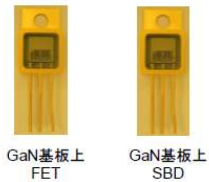
図 3-74. 搭載した GaN 基板上 FET と SBD
