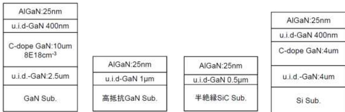
図3-79 各種基板のエピタキシャル構造
