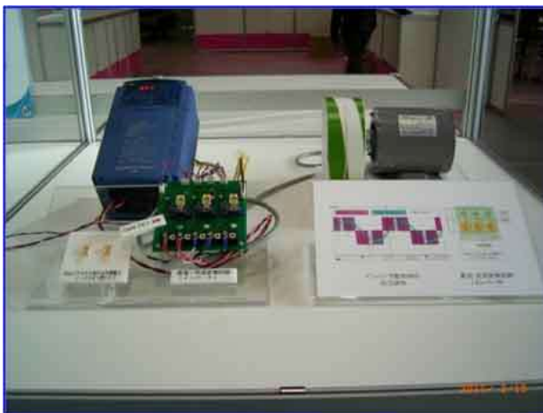
図 3-70. GaN 基板上 FET を利用したインバータ回路による三相誘導モータ駆動デモとインバータ動作時の出力波形
