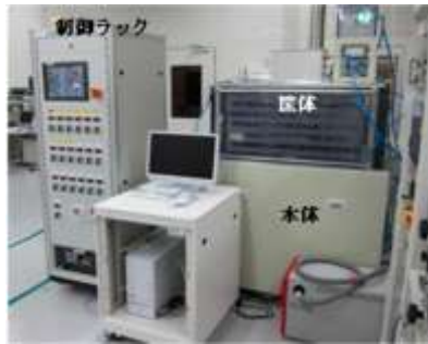
(a) 雰囲気制御評価モデル機の全体写真 (b)ヘッドシールド内配管・配線状態
