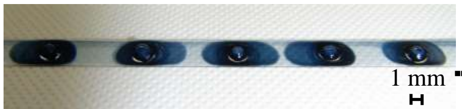
図③-(2)-3-1.13 リールツーリールシステムを用いて幅 5mm の長尺 PET リボン基材に連続的に形成した PEDOT:PSS 被覆エラストマー接点構造。
