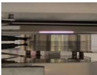
図③-(1)-2-3.60 ヒータ内蔵小型下部電極を用いた放電
