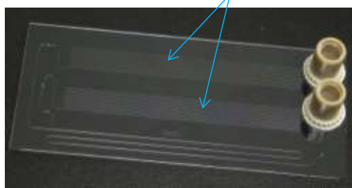
図③-(2)-2-3.30 変動抑制部を備えた改良 T 型マイクロ流路
