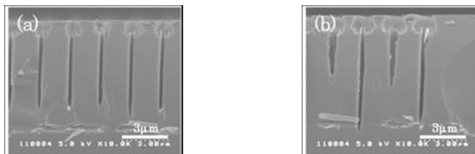
図②-(1)-1-2.8 トレンチの断面を観察した SEM 像①。(a)レーザーパルスエネルギー 50nJ、(b)60nJ にてレーザー照射を行い、その後フッ酸によってエッチングを実施。
