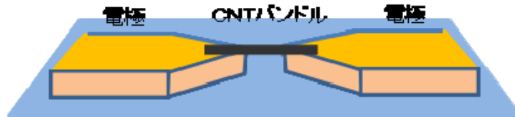
図 -(2)-1-3.3 電極間に架橋した CNT バンドルの概略図
