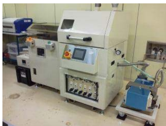
(b) 真空リフロー装置
