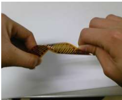
図①-(2B)-2-4-2.3 作製したフレキシブル熱電モジュールの写真
