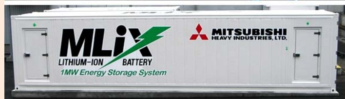
写真:出力1000kWのコンテナ型システム(蓄電容量408kWh、リチウム電池2000個以上内蔵、長さ40フィート) 三菱重工HP
