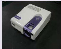
熱電変換モジュール外観 試作プロジェクター外観 ※開放電圧8.18V、最大電流値0.60A、最大発電力1.24W (写真提供: (財)エンジニアリング振興協会HP)
