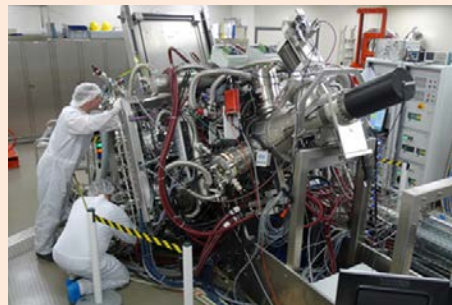
DPP方式EUV光源(量産試作露光装置用) 説明と写真:ウシオ電機_HP
