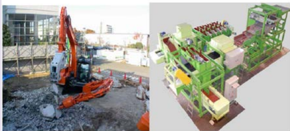
特殊環境用ロボット分野: 建設系産業廃棄物処理RTシステム
