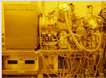
MIRAIプロジェクトで使用されたDPP方式EUV光源 (写真:ウシオ電機_HP)
