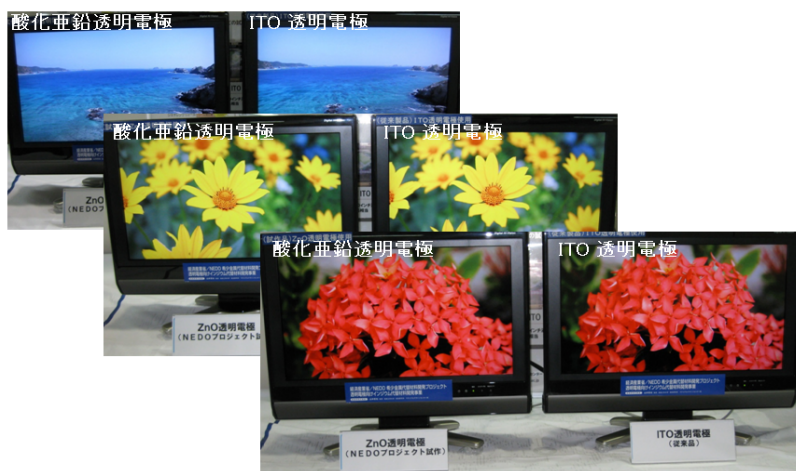
図3.76 C F基板側透明電極に酸化亜鉛透明導電膜を用いた20インチテレビと従来品の汎用品と同様にITO膜を用いたテレビの表示状態比較 (nanotech 2012, 東京ビッグサイトにて展示)
