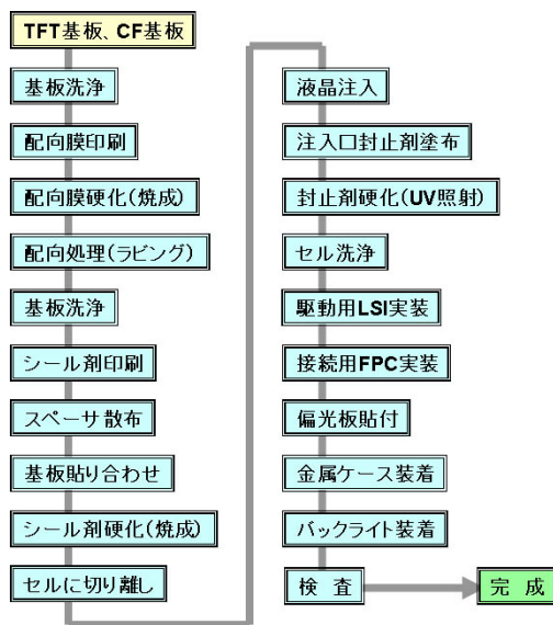
図3. 71 ZnO 透明導電膜形成以後の 3インチ液晶パネル組み立て工程流れ図
