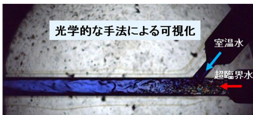
図 2.3.3.1-1 光学セルを用いた混合状態の可視化
