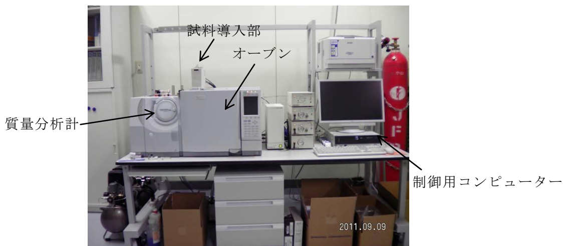
図 2.3.1.3-4 加熱発生ガス分析および昇温脱離ガス分析装置外観
