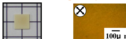
図 3.2.2.1.2.2-1 DGETP-Me と DGETP-tBu/m-PDA 系硬化物の外観写真および偏光顕微鏡観察
