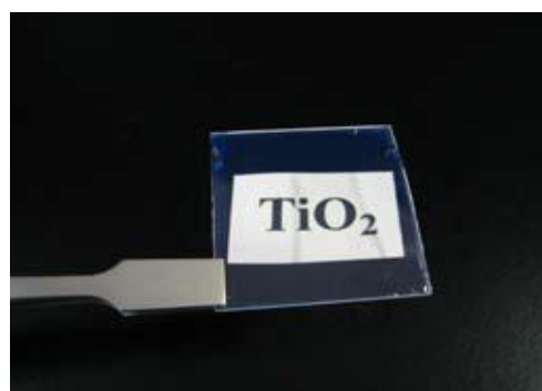
図 2.3.3.2-2 2段階重合による作製した \text{TiO}_2 ナノハイブリッドポリマーの写真
