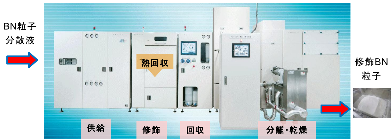
図 2.3.1.3-1 大型流通装式超臨界水熱合成装置
