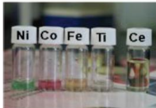
図 2.2.1.1-3 超ハイブリッド粒子の構造(左)と有機溶剤中への均一分散(右)
