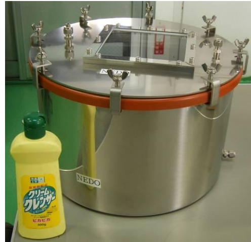
図Ⅲ-2-②-5 20L窓付き小型チャンバー
