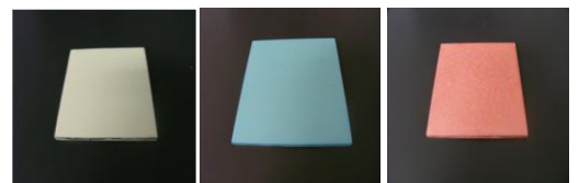
図Ⅲ-2-④-15 スプレーコートで得られたコーティング膜。基材：セラミックス板。膜厚 200 μm
