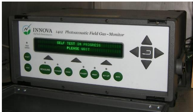
図III-2-②-2 光音響マルチガスモニター（本体）
