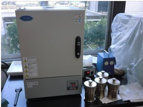
図III-2-②-12 水熱処理で使用した高圧用反応分解容器 (100mL×4 個、右下) と、強制対流式乾燥器 (左)
