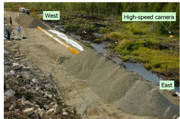
図 4 実大バースト試験体の設置状況
