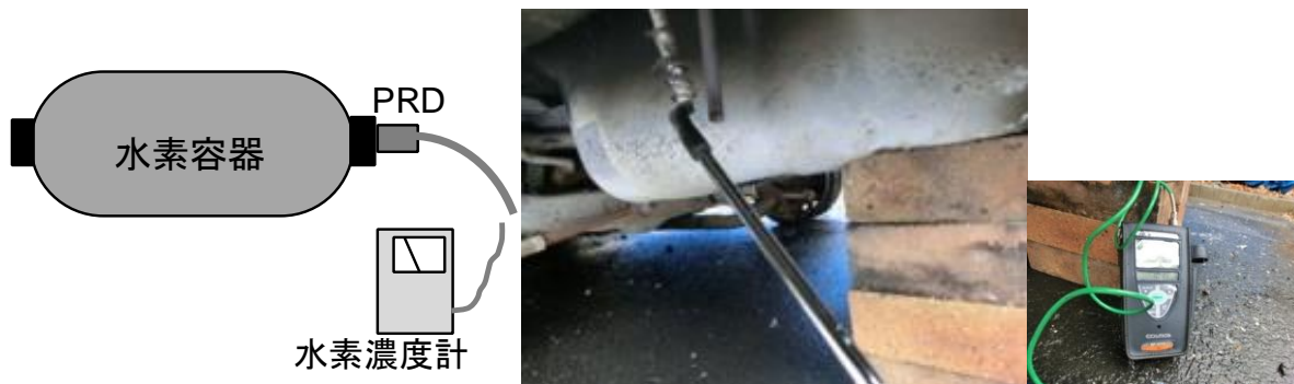
図13 焼損車両のベント管での水素濃度計測
