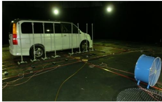
図9 送風状態での車両周囲の水素濃度計測
