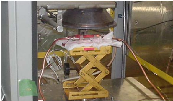
輻射熱による安全弁動作試験
