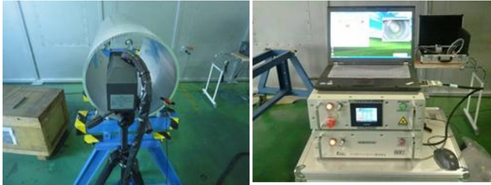
図17 探傷検査機(レーザー超音波方式)
