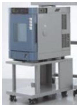
図Ⅲ-2-(ホ)-A-1(53) 恒温恒湿槽の一例：東芝所有（-40～150度）
