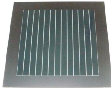
図Ⅲ-2-(ニ)-A-1(24) モノリシック構造 (写真)
