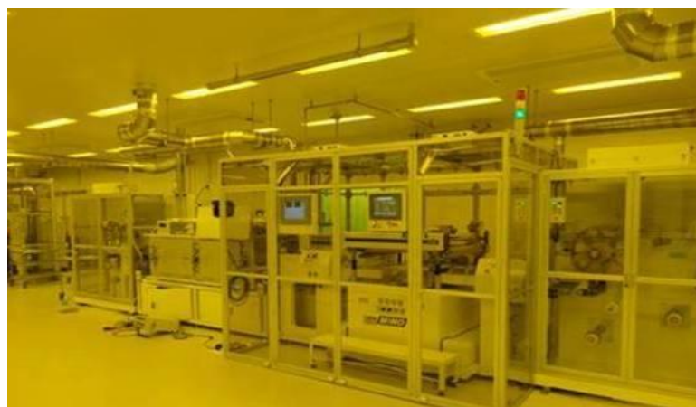
図Ⅲ-2-(ホ)-A-1(58) ロール to ロールスクリーン印刷ライン (H23 年度導入)
