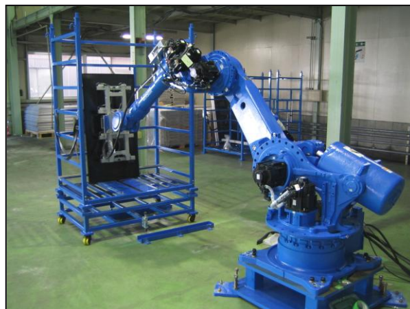
図Ⅲ-2-(~)-E-1(6) モジュールローダー・アンローダー及びカセット
