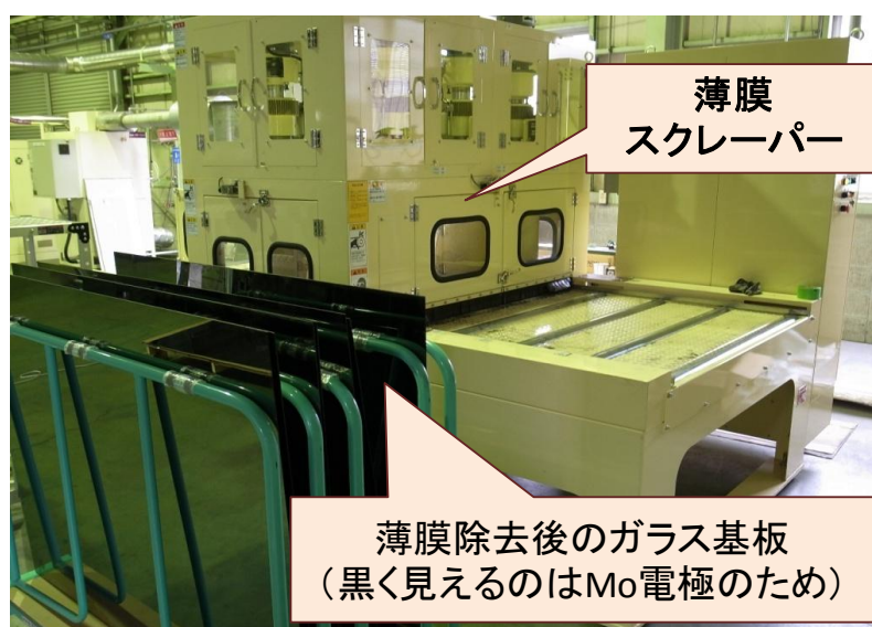
図Ⅲ-2-(へ)-E-1(9) 試作した薄膜スクレーパーと処理済のガラス基板
