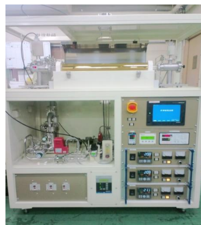
図 III-2-(ホ)-A-1(26) 結晶析出型昇華精製装置
