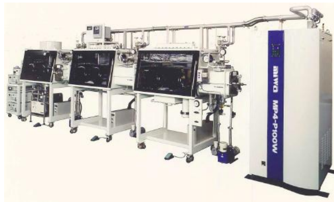
図 III-2-(ホ)-A-1(32) セル作製/評価用グローブボックスシステム
