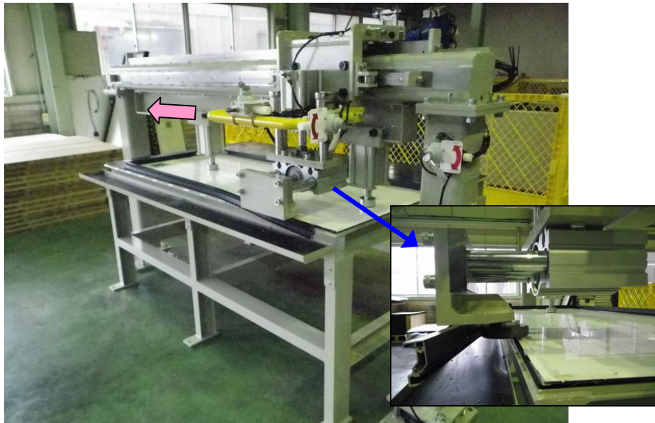
図Ⅲ-2-(へ)-E-1(8) 非加熱式アルミ枠解体支援装置
