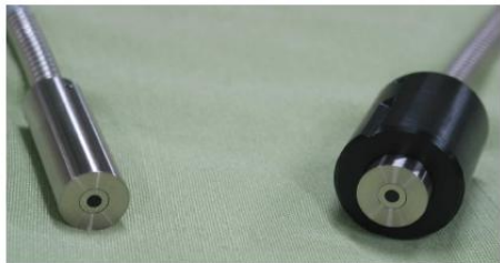
グローボックス照射用光ファイバ 出射口 Φ4mm
