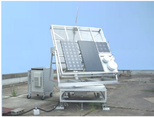
図Ⅲ-2-(へ)-D-1(22) 太陽電池屋外高精度性能評価装置(左図)と、屋外測定と屋内測定の各太陽電池パラメータの比較結果(単結晶 Si モジュール)
