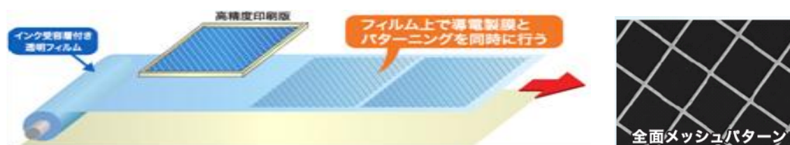
図Ⅲ-2-(ニ)-C-1(9) メタルメッシュ基板の製造例とメッシュパターン
