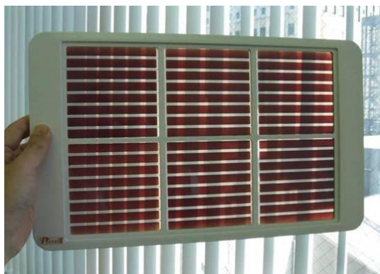
図III-2-(ニ)-C-1(10) 両面発電型モジュールと光量変動と出力の関係
