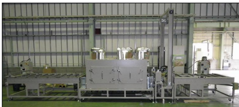
図Ⅲ-2-(へ)-E-1(2) 加熱式バックシート剥離装置（構成図）
