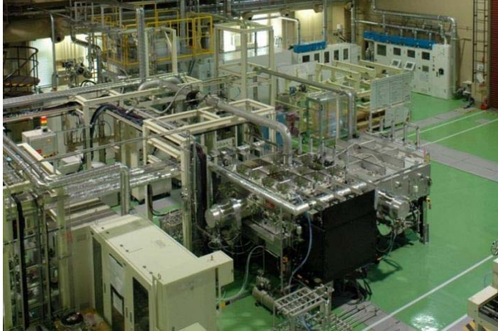
第5世代サイズガラス基板を処理できる開発したCVDチャンバー
