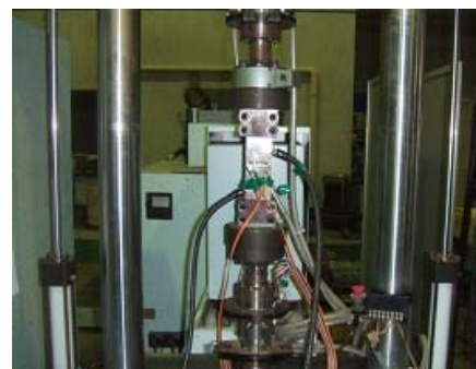
図①-3)-62 先進的な伝播モニタリング技術を実現した電場指紋照合装置
