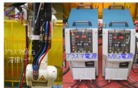
図①-1)-10 試作プラズマMIG溶接装置（協調電流制御電源）
