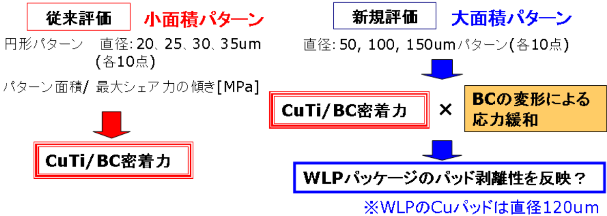
図 2. 3. 4-24 試料構造と、シエア試験の従来と今回の違いの比較
