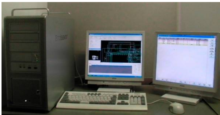
図 3.4.2.12 走行プログラム自動生成システム
