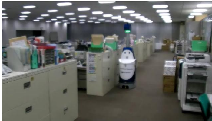
図 3.4.2.9 専用部小型清掃ロボットの有効性検証（住友商事八重洲ビル）
