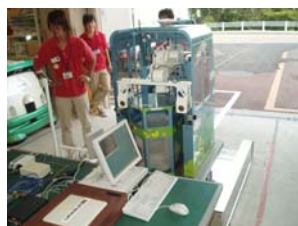
屋外での IC タグを用いた ゴミ箱搬送・計量システム (愛知万博での実証試験)
