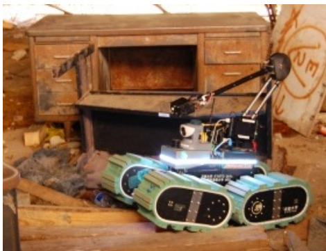
Fig. 125 RT ミドルウェアで実装済み研究用災害対応ロボット「KOHGA3」
