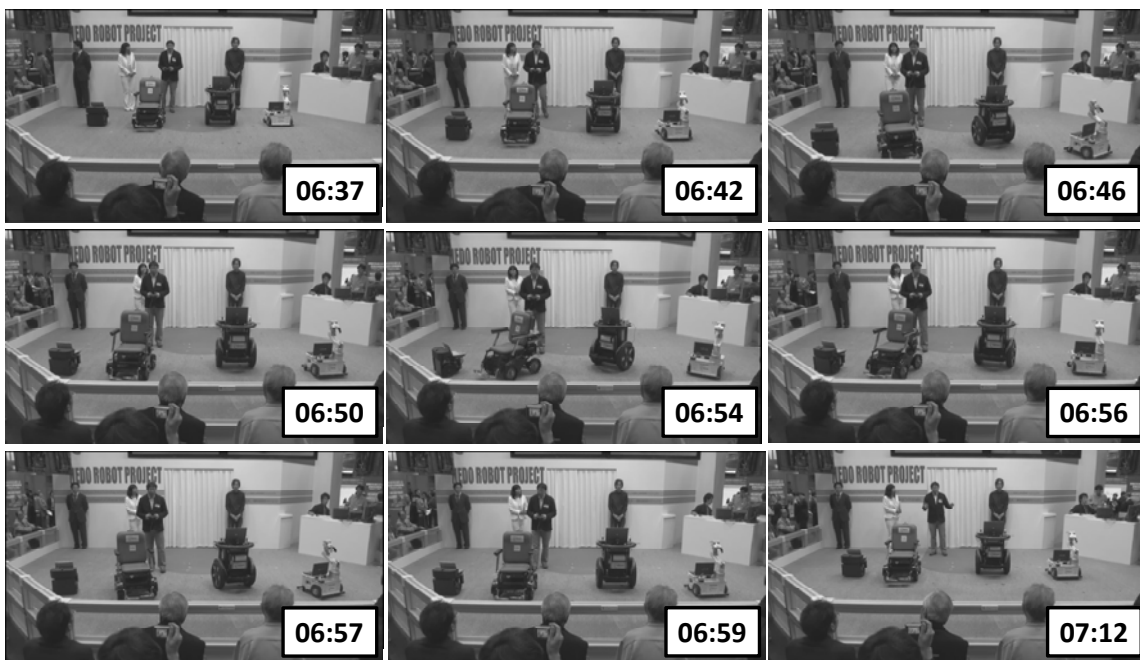
Fig. 102 単一走行指令に同期して動作する4台のロボット (右下数字は経過時間)
