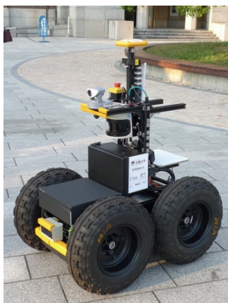
Fig. 126 RT ミドルウェアで実装済み研究用災害対応ロボット「MATOI」
