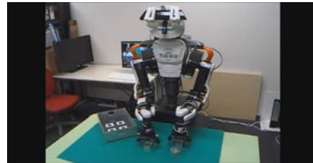
東京大学 手先カメラを用いた双腕ロボットによるマニピュレーション作業システム
