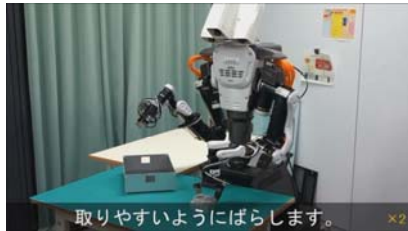
AIIST 頭部ステレオカメラを用いた双腕ロボットによるマニピュレーション作業
