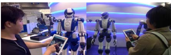
作業移動ロボットによるRTMコントローラとROSユーザインタフェースの連携検証
