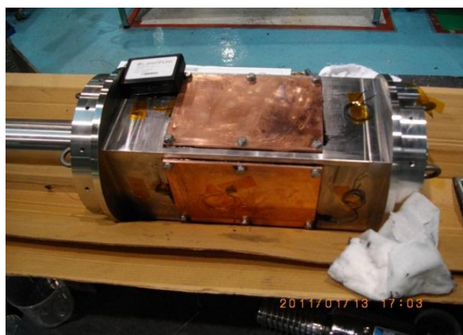
図 2.3.3-5 回転部の外観：この中に液体 Ne が流し込まれる。1000rpm 程度で回転させて、これに取り付けた温度計で各部の温度を測定した。
