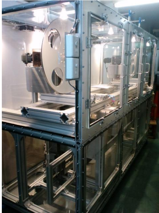
図 2.1.2-28 リール式複合材料搬送機構の写真
