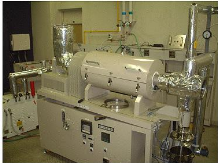
図Ⅲ.2.3-31 切削粉脱脂装置
