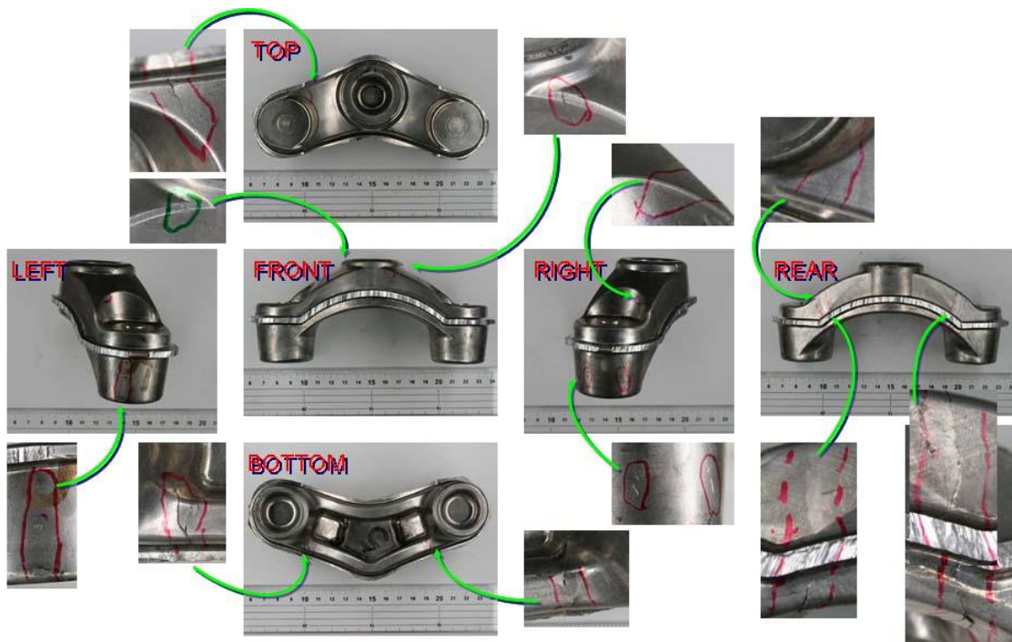
図 2. 1. 1-2 クラウンの外観写真 (素材:AZ80, 材料温度:250℃, 型温度:150℃)
