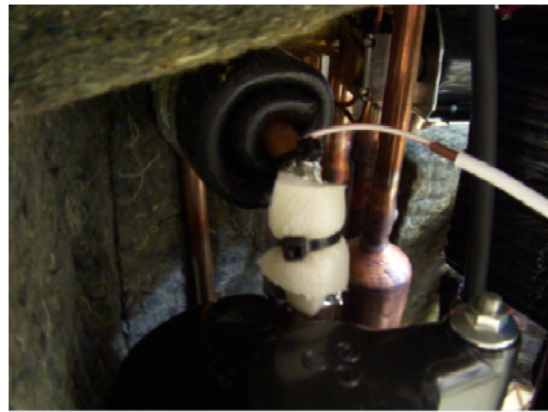
図 4.2.4 A 社のエアコンに張り付けた熱電対 (左図：室内機入口温度計測用熱電対 右図：圧縮機入口温度計測用熱電対)
