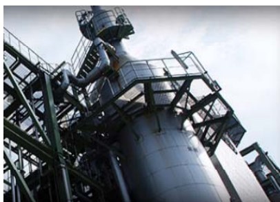
下水汚泥ガス化 発電システム
