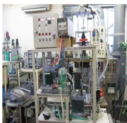
図Ⅲ. 2. 6-57 連続電解析出実験装置
