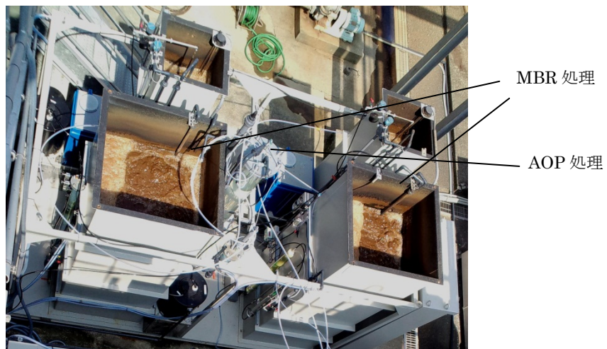
図Ⅲ. 2. 7-17 ジオキサン連続処理フロー
