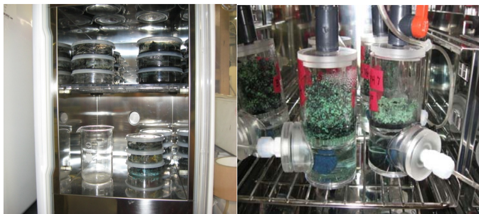
図Ⅱ.2.1.6-2 恒温槽内シャーレ（左）、および酸化促進器（右）による硫化ニッケル汚泥の酸化実験
