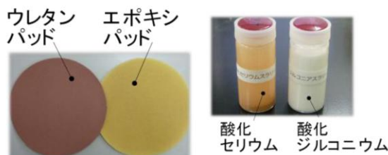
図Ⅲ-1-2 開発したエポキシ樹脂研磨パッドと代替砥粒
