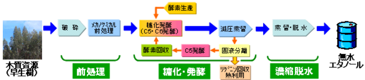
図 III-2-6 早生樹からの効ケミカル前処理によるエタノール一貫プロセス
