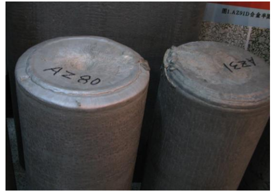
図2. 1. 6-4 鋳型内電磁攪拌鋳造した鋳片
