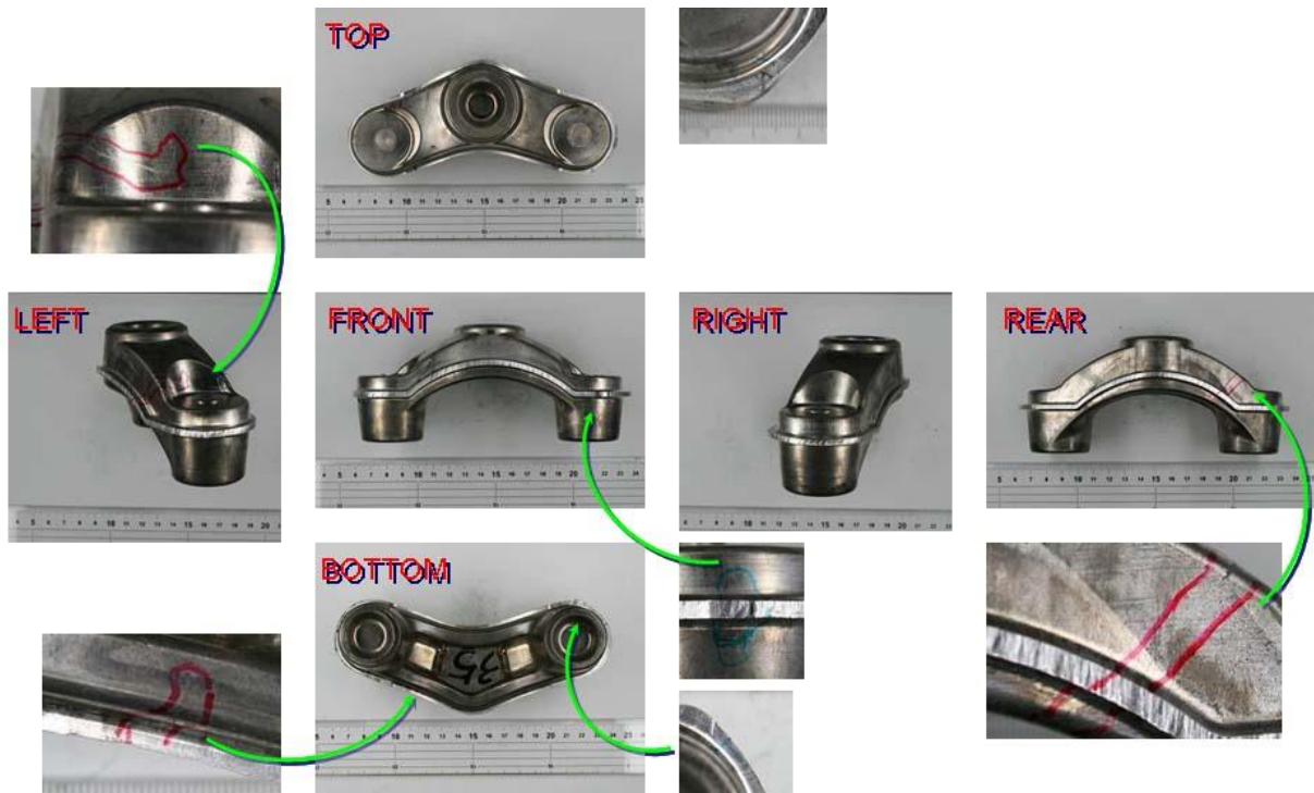
図2. 1. 1-3 クラウンの外観写真（素材:AZ61, 材料温度:400℃, 型温度:150℃）
