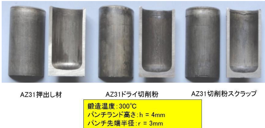
図Ⅲ.2.3-74 各固体リサイクル材の 300^\circ\text{C} での後方押し試験後の外観
