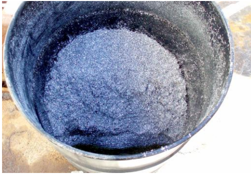
図Ⅲ.2.3-13 再生工場に搬入されたマグネシウム切削粉の性状1(廃油漬け)
