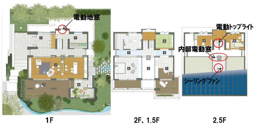
図 c-1-16 建物BのRT関連設備機器配置
