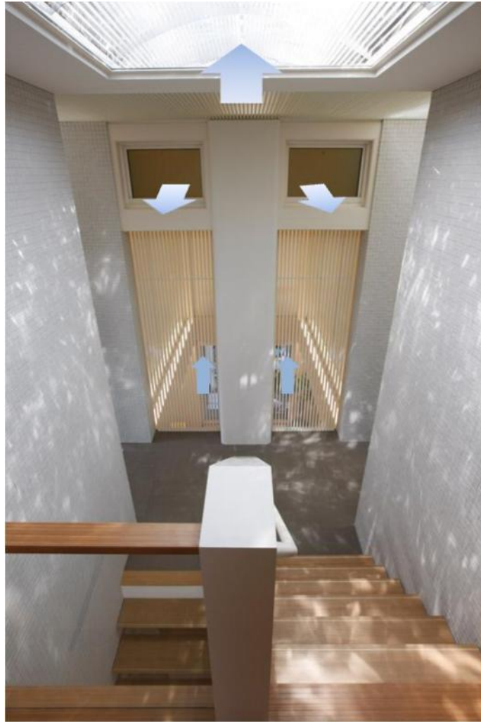
図 c-1-9 インテリジェント空調システムの通風経路例
