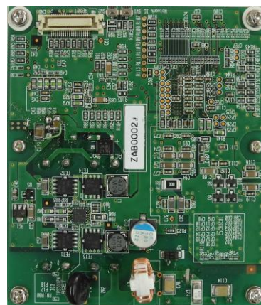
図 a-1-4 電源/PLC 部
