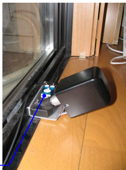
図 b-1-22 インテリジェントウインドウシステムにおける 小型通信ドライバモジュールの配置
