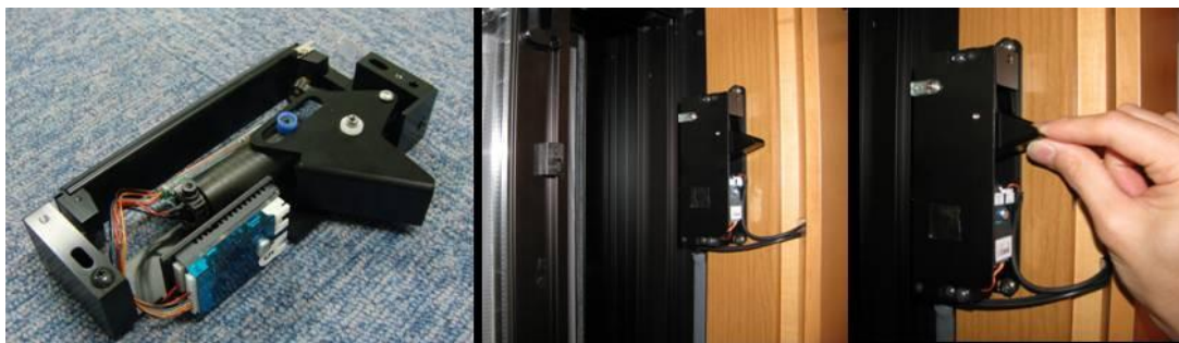
図 b-1-30 窓施錠ユニット (左図: 構造→小型リニアアクチュエータ内蔵 中央: 設置概観 右図: 手動開錠)
