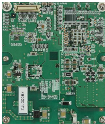
図 a-1-12 電源/PLC 部
