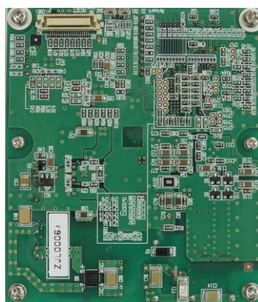
図 a-1-20 電源/PLC 部
