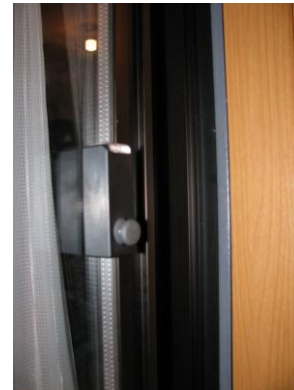
図 b-1-27(右図) パワーアシストスイッチおよびタッチセンサ(グレー部分)
