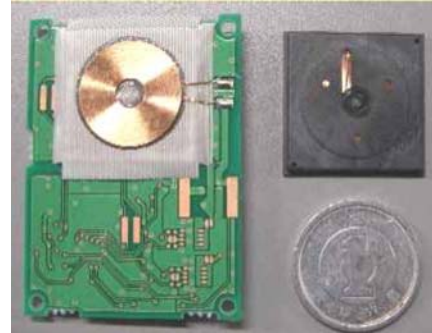
図 V.1.4.3 (vii) .4 非接触充電モジュールの特長と外観
