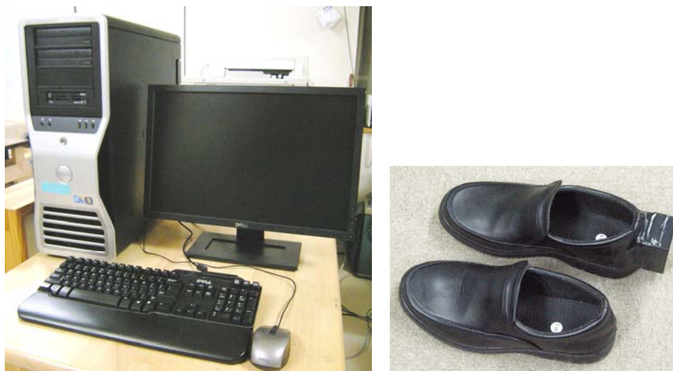
図V.1.4.3 (vii) .2 左 サーバ、右 モジュール装着状態
